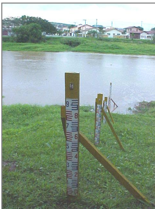
FIGURA 3.7 - Réguas para mediação do nível do Rio Paraíba do Sul, situadas na captação de água da ETA Central - Jacareí - São Paulo
