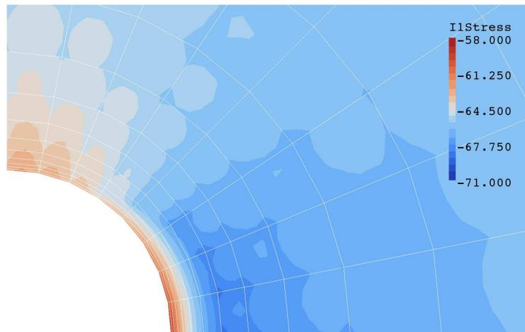
c) Distribuição final do primeiro invariante de tensões ( $MPa$ )
