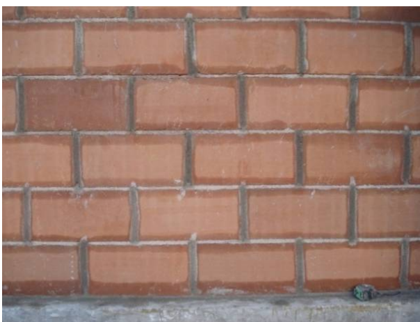
Figura 7.10: Montagem da parede para o teste de isolamento sonora. As juntas verticais e horizontais foram cuidadosamente preenchidas com argamassa.
