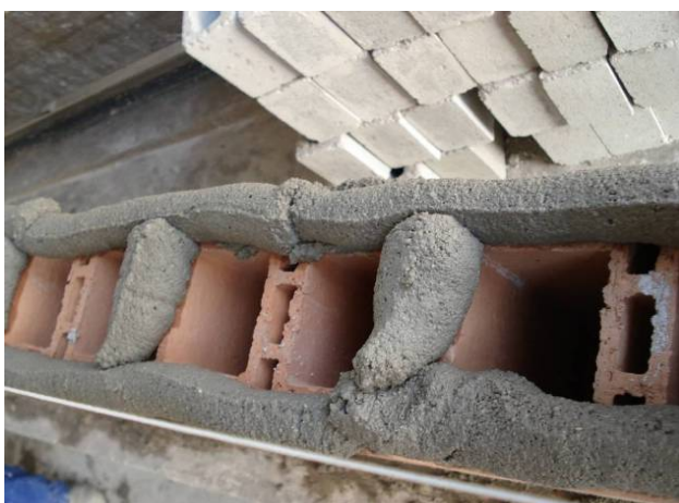
Figura 6.2: Montagem de parede para teste de isolamento sonora, com detalhe à colocação da argamassa.
