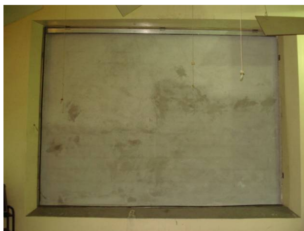
Figura 7.3: Parede posicionada entre-câmaras para a realização do teste de isolamento sonora.
