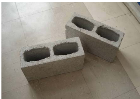
Figura 7.5: Amostra dos blocos utilizados na construção da parede avaliada em teste de isolamento sonora.
