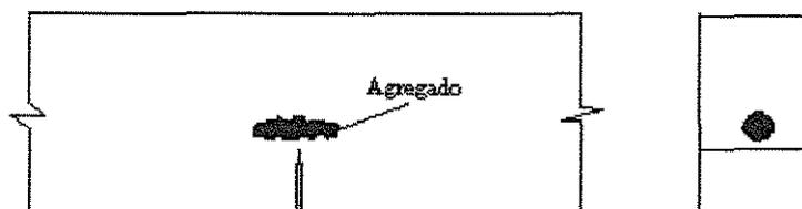
FIGURA 7.1 - Agregado de forma alongada, posicionado sobre a raiz do entalhe.
