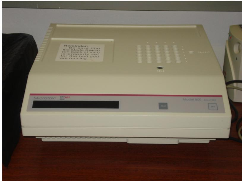
**Figura 4.8. Analisador de toxicidade Microtox®.**
