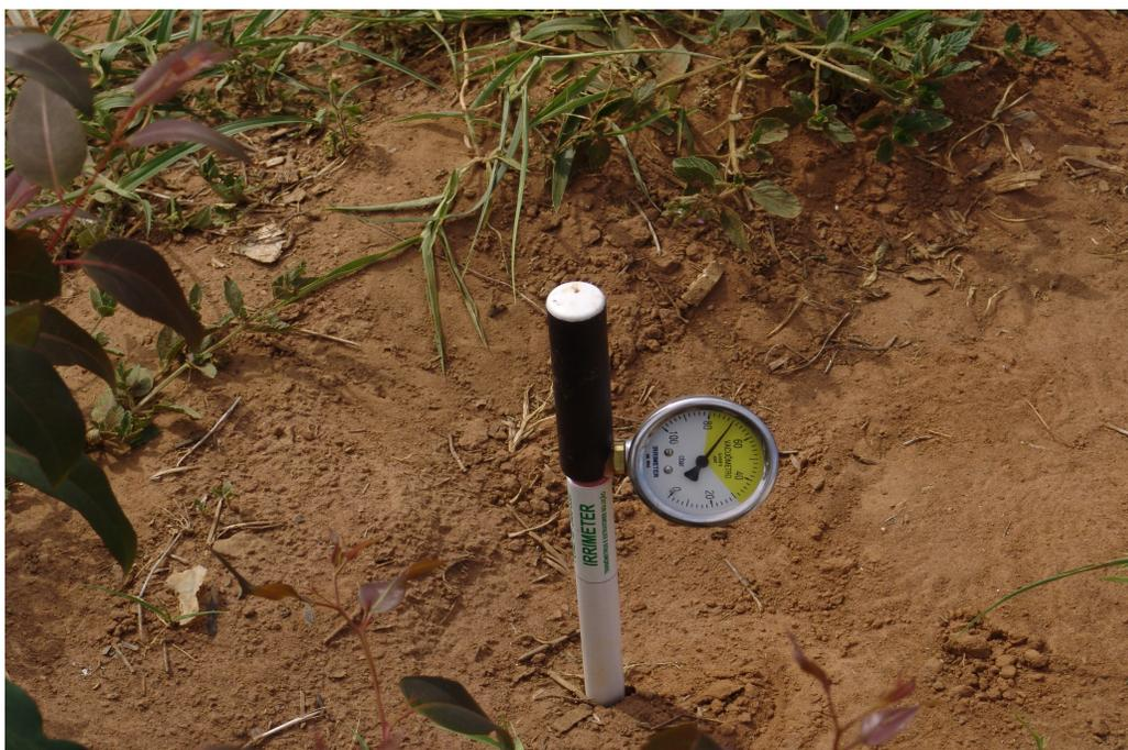
**Figura 4.5. Modelo de tensiômetro utilizado no experimento.**
