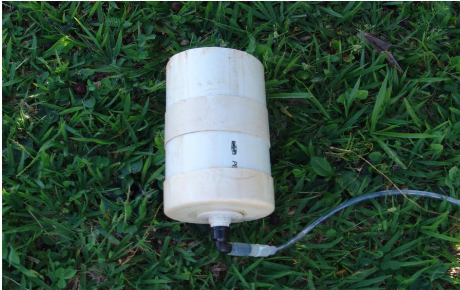
Figura 4.3. Modelo de coletor de drenagem livre utilizado no experimento.
