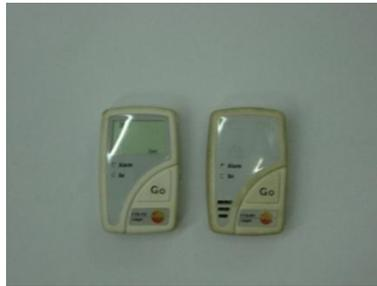
Fig.20 Registrador de temperatura de ar e umidade.
