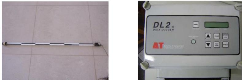
Fig.24 Solarímetro de tubo, Delta-T TS e Registrador Delta DL2
