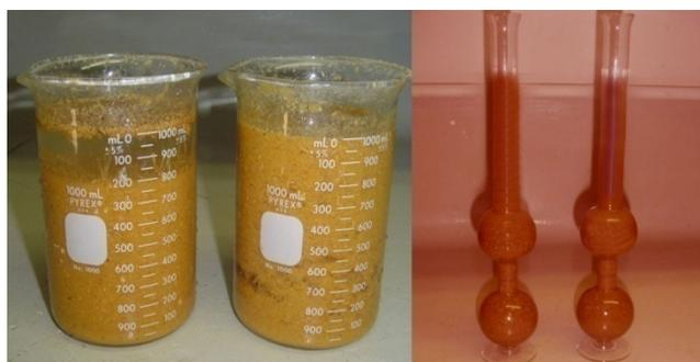
**Figura 10.** Partículas imersas em água por 24 horas e à esquerda sendo ensaiadas no Frasco de Chapman.
