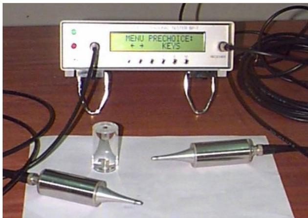
Figura 12. Aparelho Ultrasonic Tester BP7.
