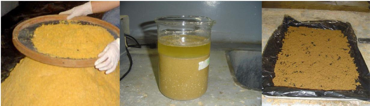
**Figura 11.** Tratamento a base de cal: a) material passado na # 4,76 – utilizado; b) PV imersa em solução a base de cal; c) PV secando por 48 horas.
