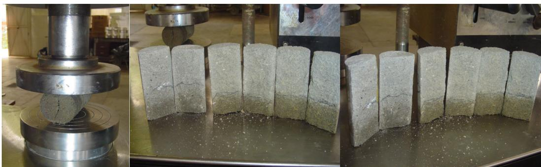
**Figura 16.** Corpos-de-prova sendo rompidos para se observar a altura da penetração de água.
