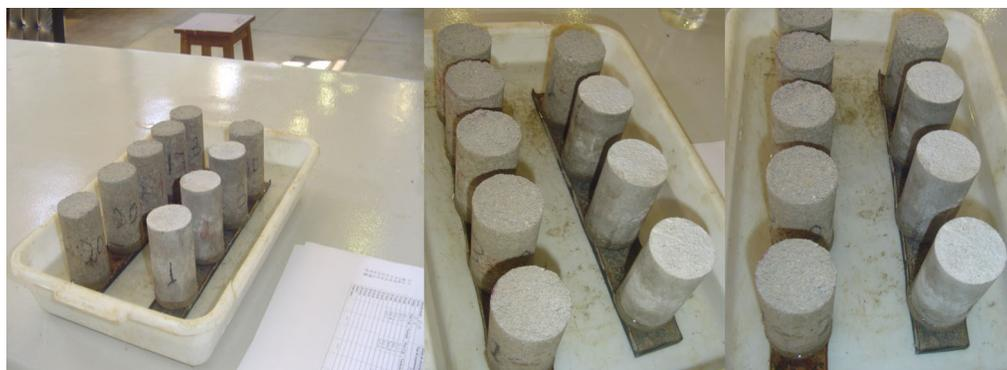
**Figura 15.** Ensaio de absorção de água por capilaridade.
