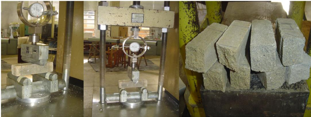
**Figura 14.** Ensaio de tração na flexão dos corpos-de-prova prismáticos, e vista após o ensaio.
