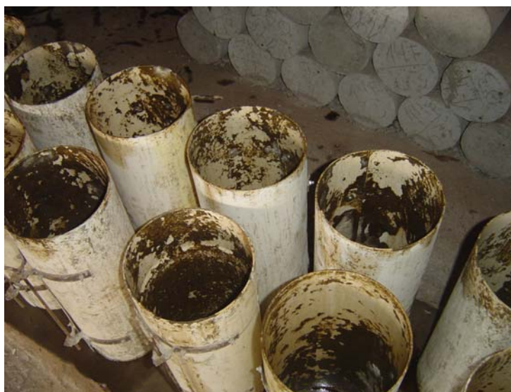
Figura 2.17 - Tubos de PVC utilizados como forma, lubrificados com desmoldante
