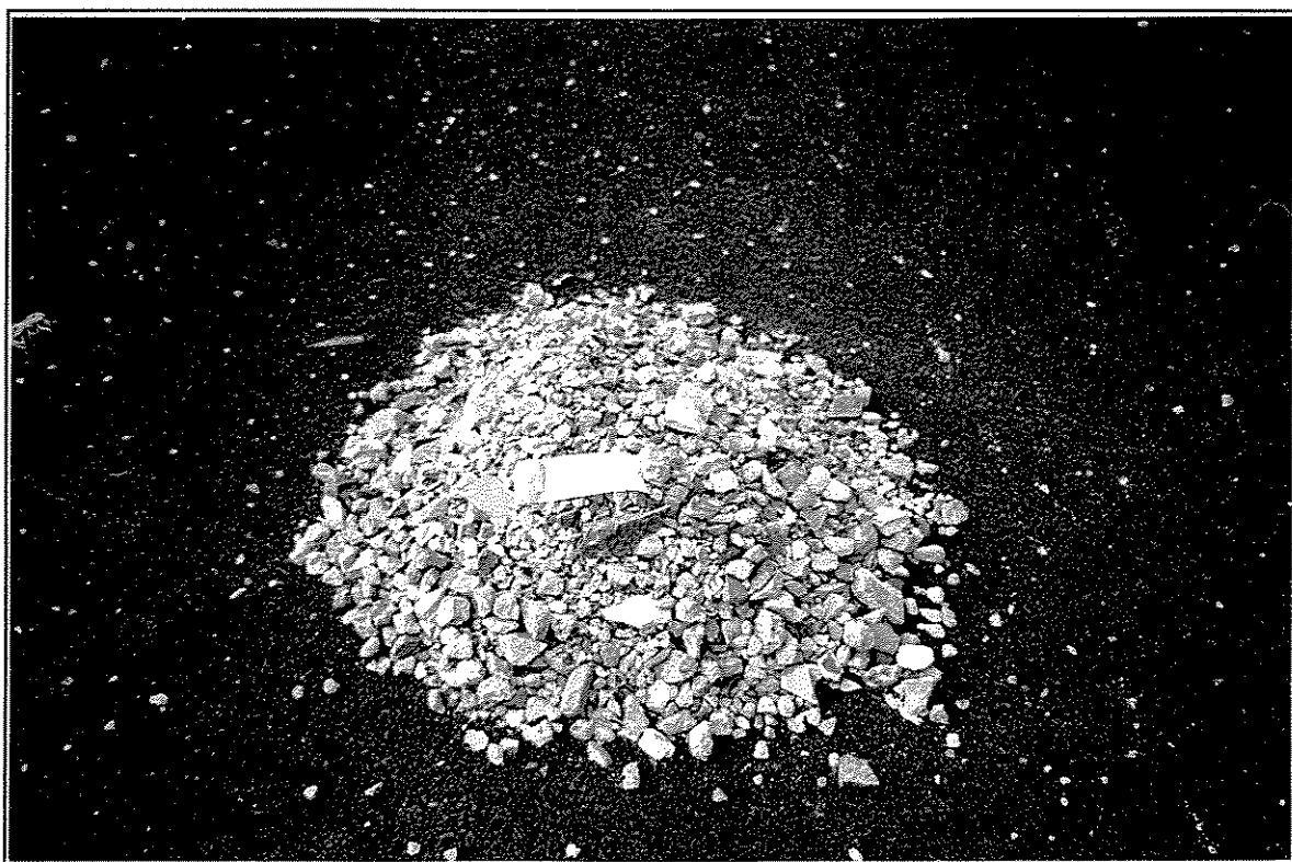
FOTO 4 - Parcela graúda do entulho utilizado como agregado.
