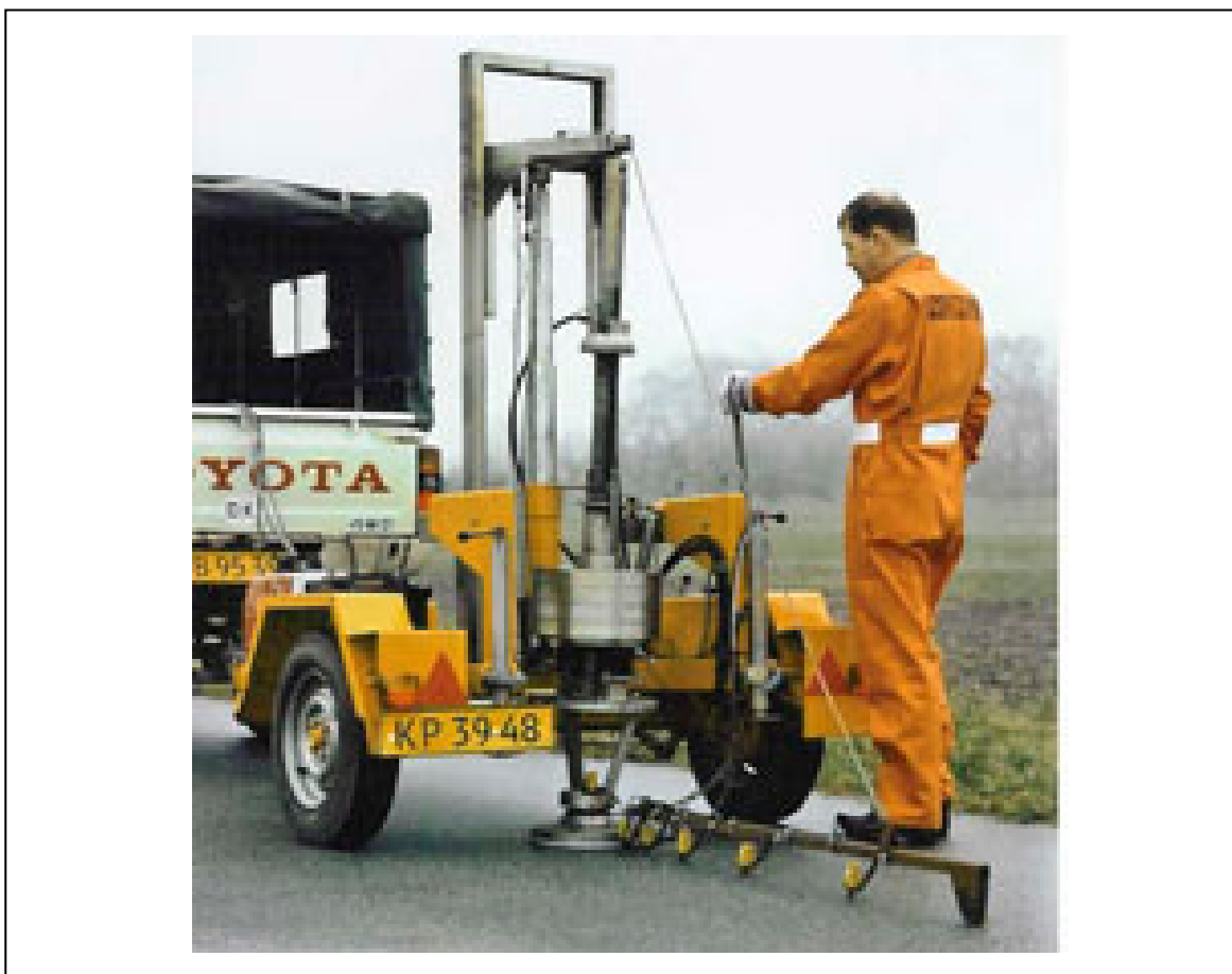
Figura 3.31 – Detalhe dos Sensores do Phoenix FWD. Fonte: Dynatest A/S PHOENIX 1981.
