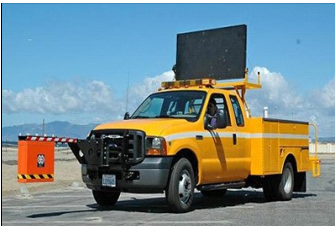
Figura 3.29 – Veículo-teste equipado com FWD e GPR (à frente do veículo). Fonte: site http:// www.jilsfwd.com/ .
