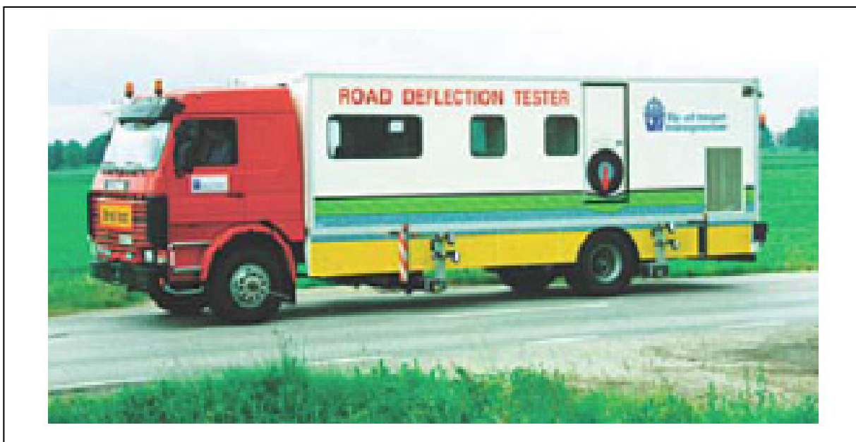
Figura 3.34 – Equipamento sueco RDT- Road Deflection Tester Fonte: Format, 2004.
