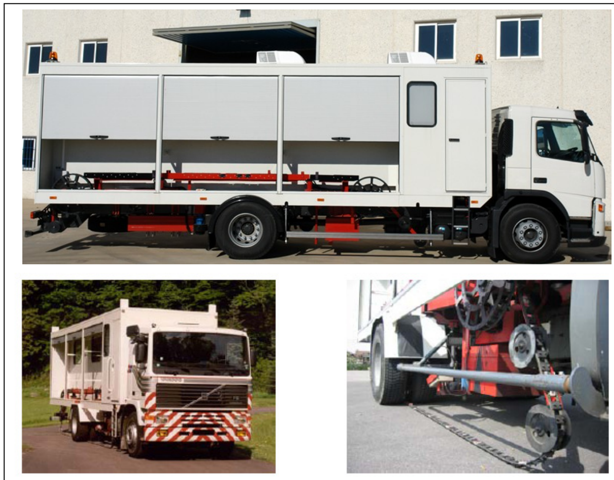
Figura 3.10 – Curviâmetro (acima e à esquerda) e corrente do Curviâmetro (à direita). Fonte: acervo Euroconsult.
