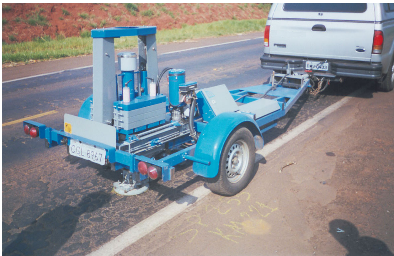
Figura 5.5 – Levantamento deflectométrico com FWD Fonte: acervo Planservi Engenharia Ltda.
