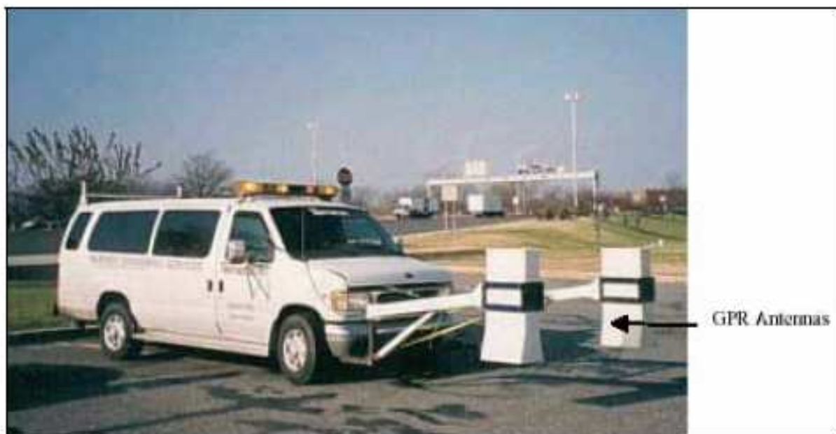
Figura 3.36 Equipamento GPR Fonte: MASER, 2001.
