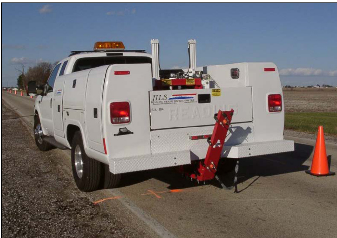
Figura 3.28 –FWD Jils instalado na plataforma de veículo utilitário. Fonte: site http:// www.jilsfwd.com/ .
