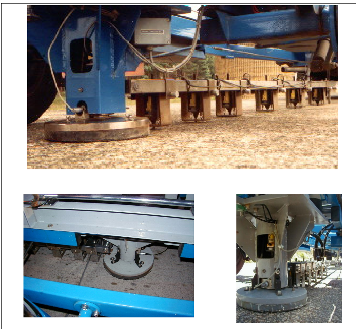
Figura 3.22 – Sensores tipo geofones de medição da deflexão. Fonte: WSDOT.
