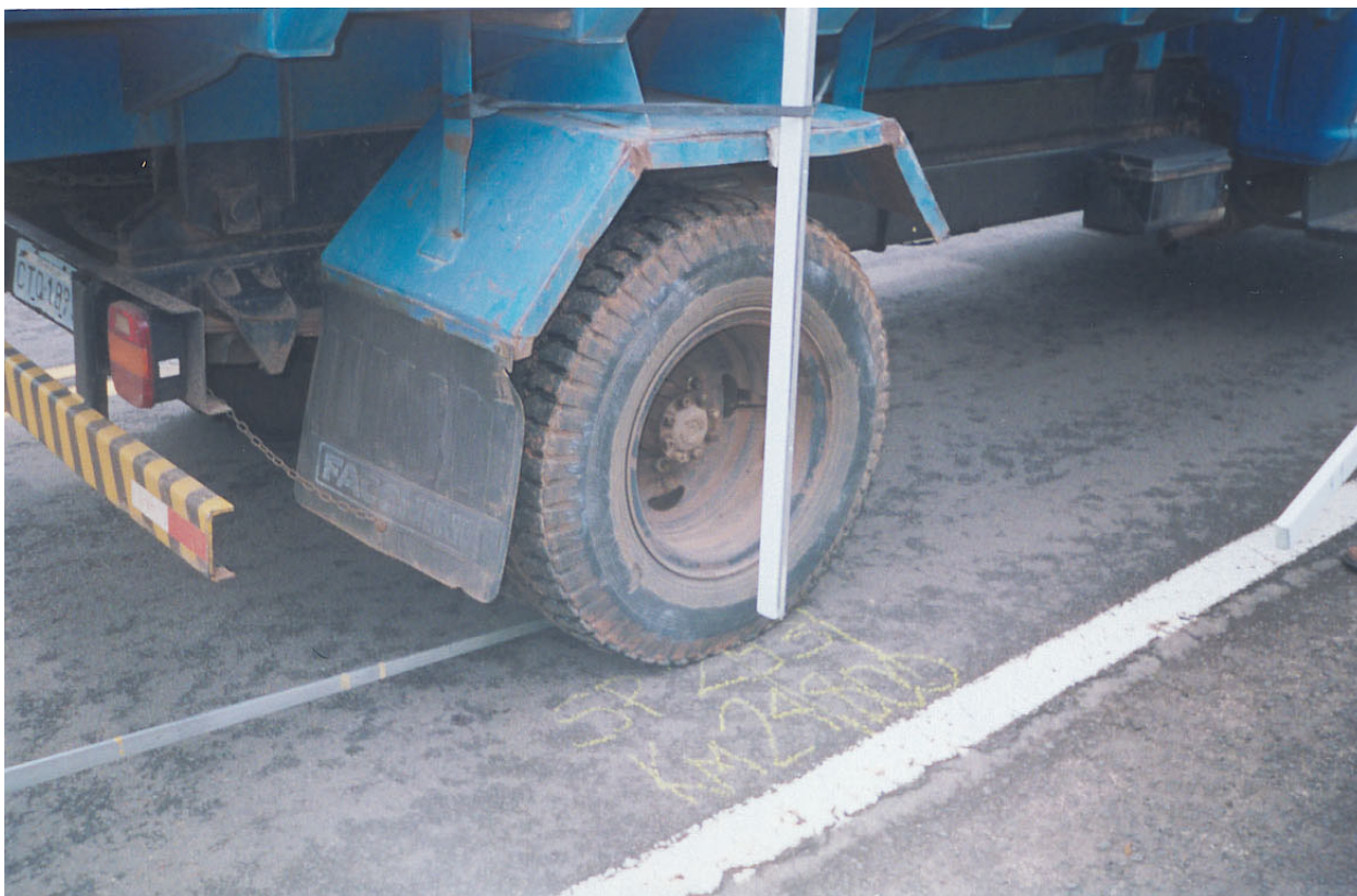
Figura 5.6 – Levantamento deflectométrico com Viga Benkelman Fonte: acervo Planservi Engenharia Ltda.
