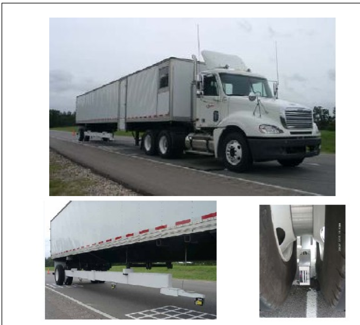
Figura 3.33 - Equipamento americano RWD (acima) barra com sensor (à esquerda) e sensor laser posicionado entre as duas rodas (à direita) Fonte: Format, 2004.
