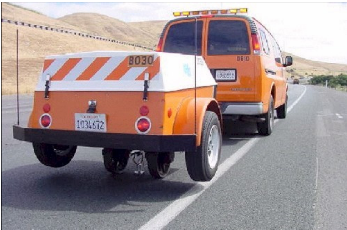
Figura 3.15 Equipamento Dynaflect. Fonte: acervo WSDOT.
