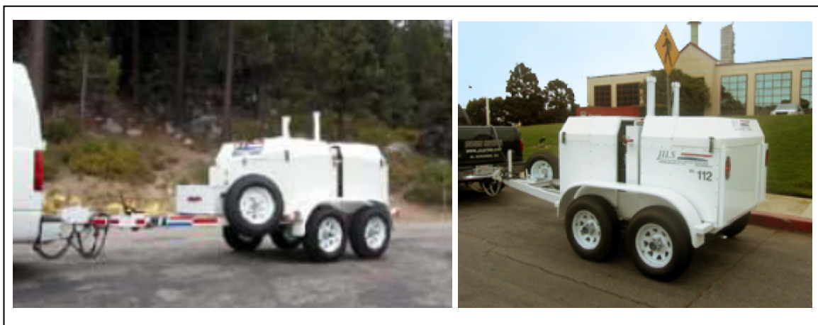
Figura 3.27 – Equipamento FWD para ensaios em pavimentos aeroportuários. Fonte: site http://www.jilsfwd.com/ .
