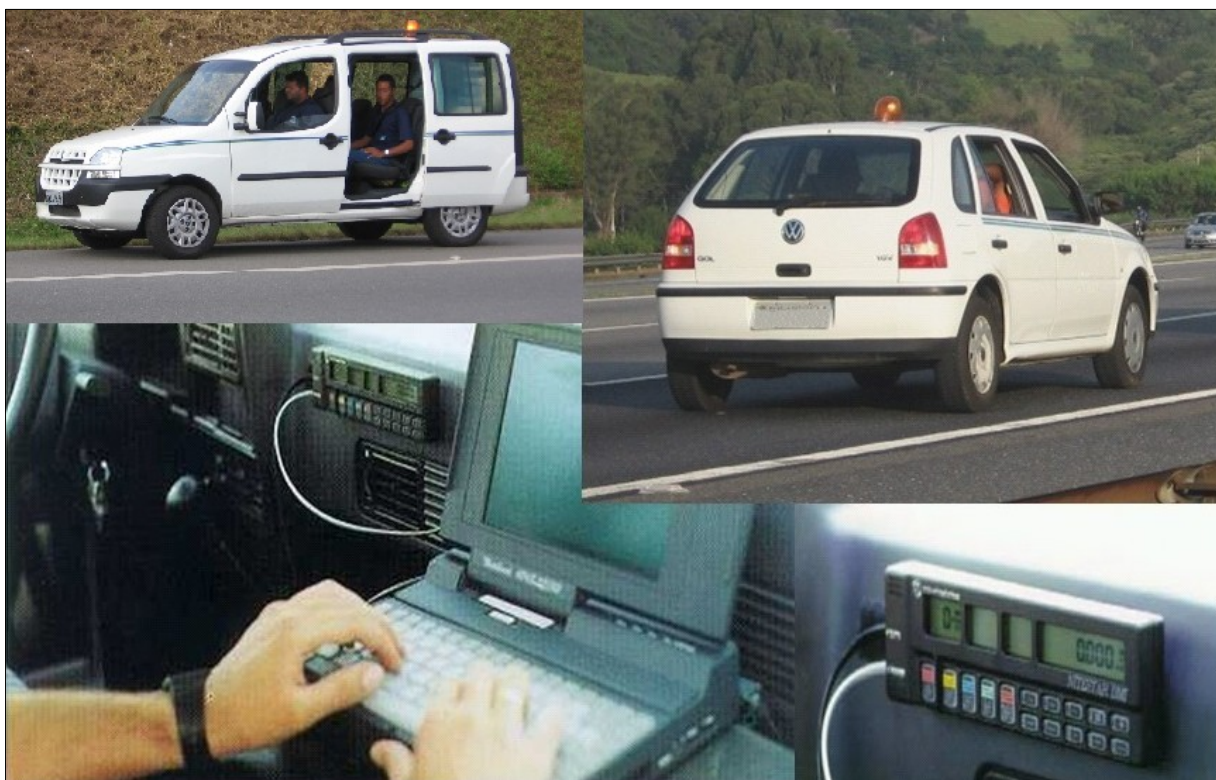
Figura 2.4 – Equipamentos de avaliação superficial subjetiva. Fonte: acervo Copavel Engenharia e Consultoria Ltda.
