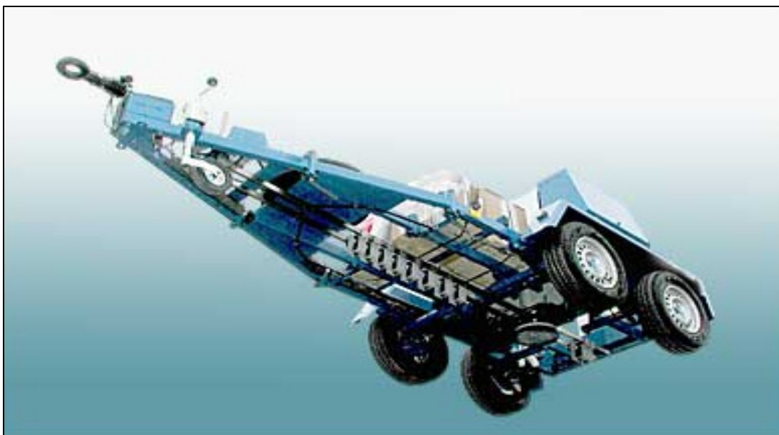
Figura 3.21 – Vista inferior do Deflectógrafo. Fonte: http://www.dynatest.com/ .
