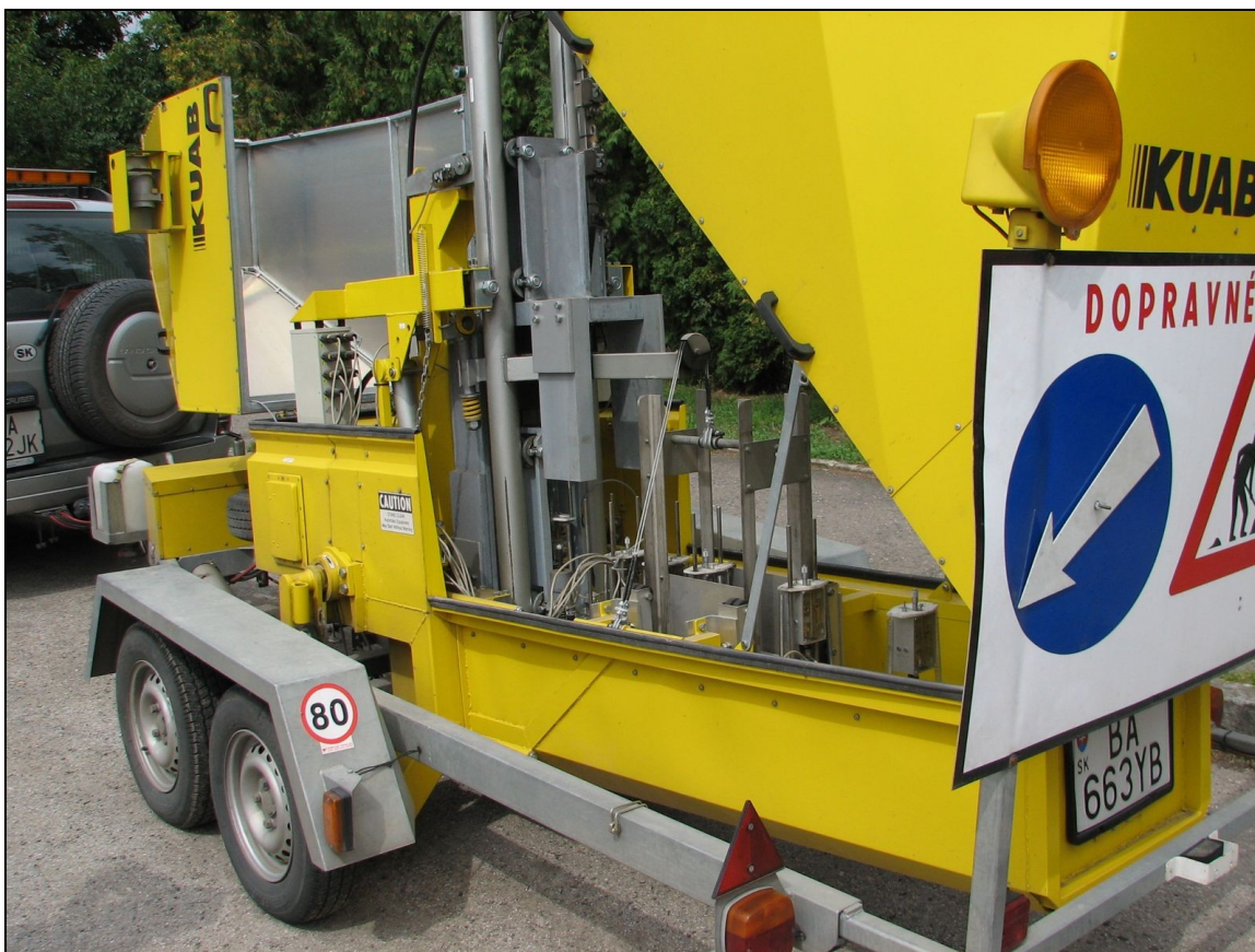
Figura 3.26 – Vista interna do Kuab FWD. Fonte: site http://www.ssc.sk/user/ .
