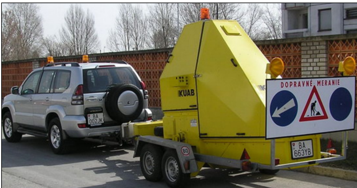
Figura 3.25 – Equipamento Kuab FWD. Fonte: site http://www.ssc.sk/user/ .
