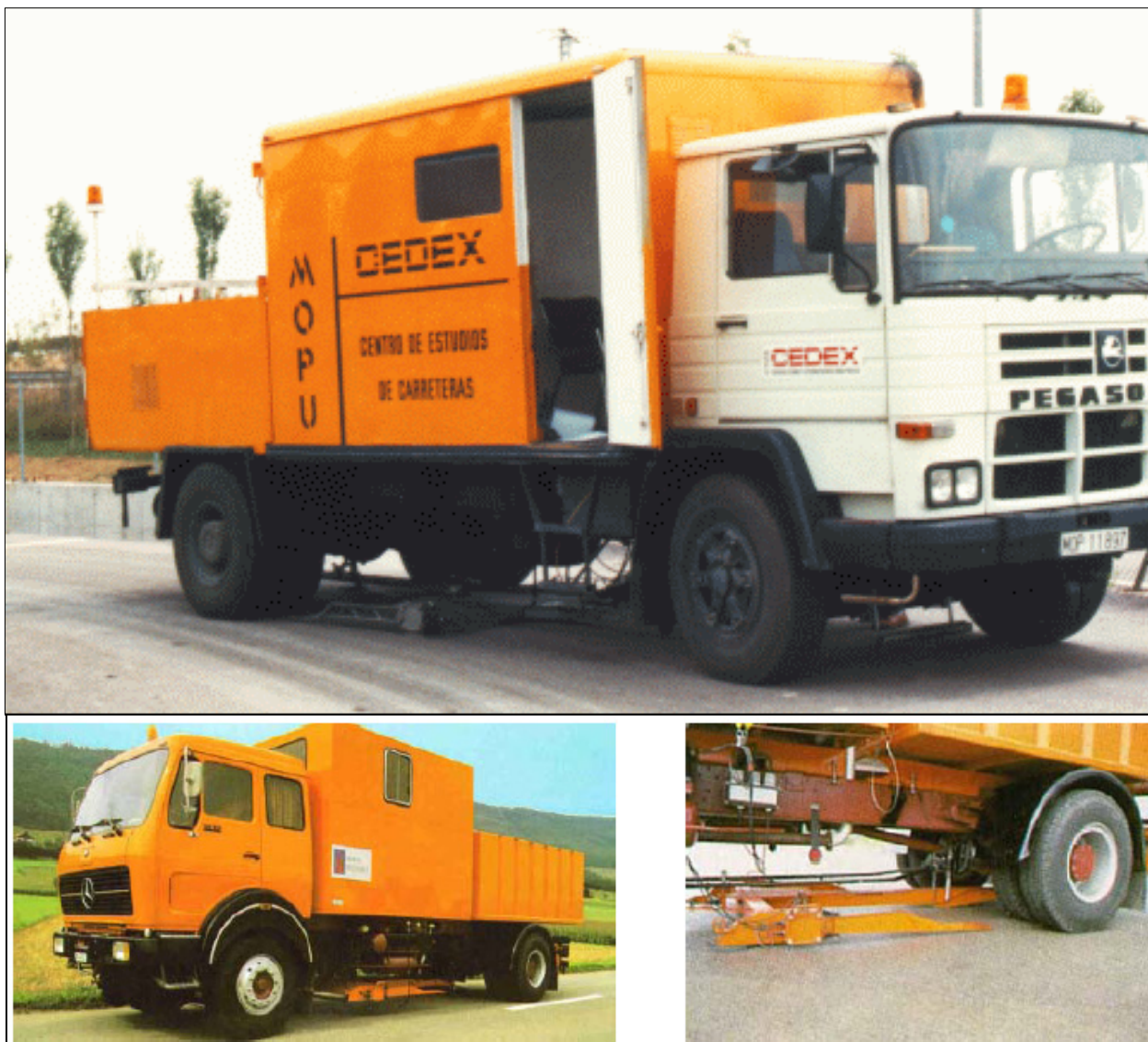
Figura 3.6 – Deflectógrafo Lacroix (acima e à esquerda) e viga em posição de ensaio (à direita) Fonte: site http://www.cedex.es/cec .
