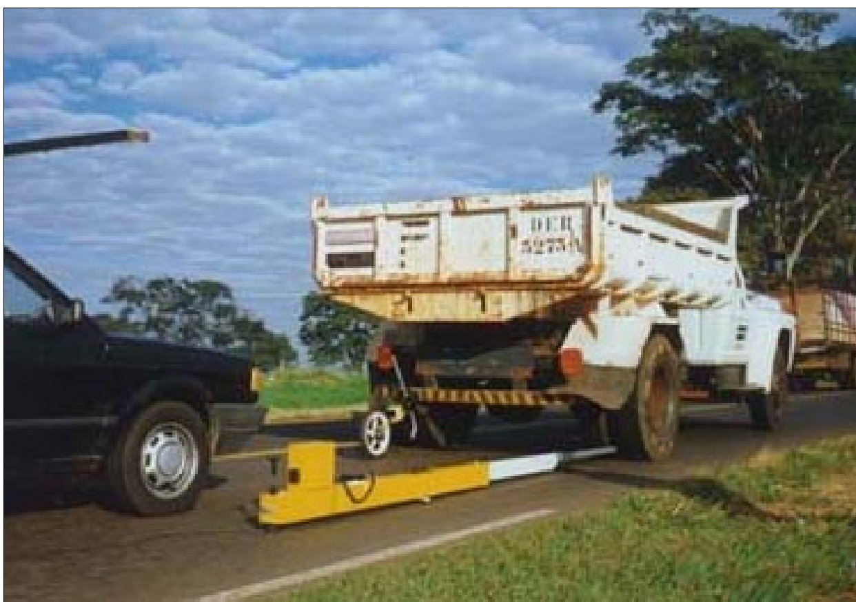
Figura 3.7 – Viga Benkelman automatizada. Fonte: acervo empresa Solotest.
