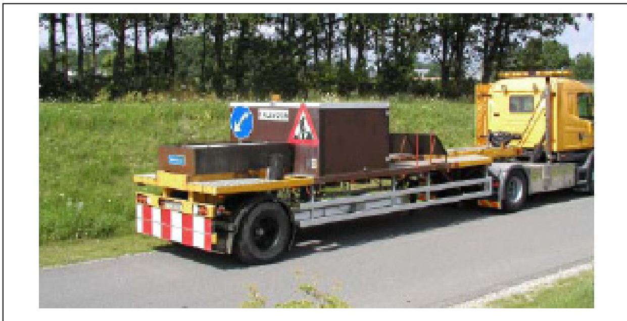
Figura 3.35 Equipamento Dinamarquês HSD-High Speed Deflectograph Fonte: Format, 2004.
