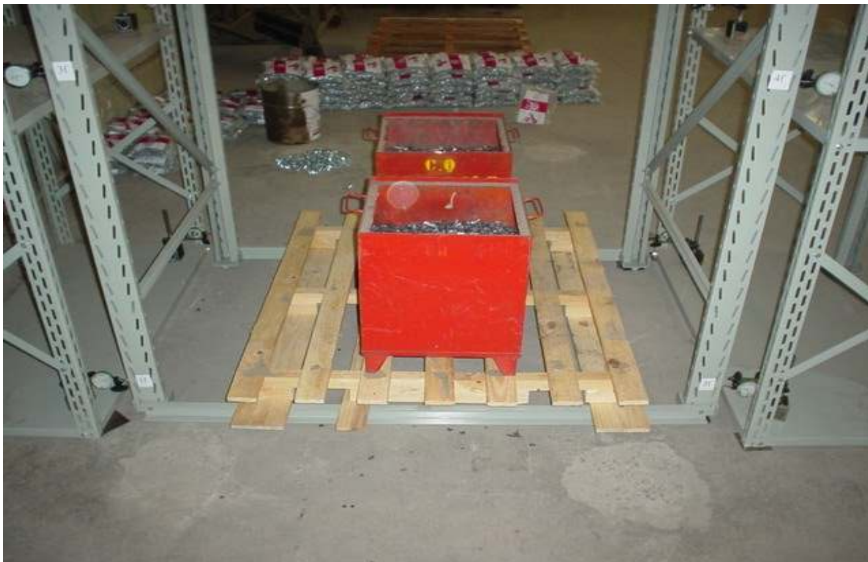
Figura 60 – Carga sobre a travessa de amarração inferior
