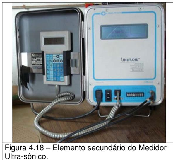
Figura 4.18 – Elemento secundário do Medidor Ultra-sônico.
