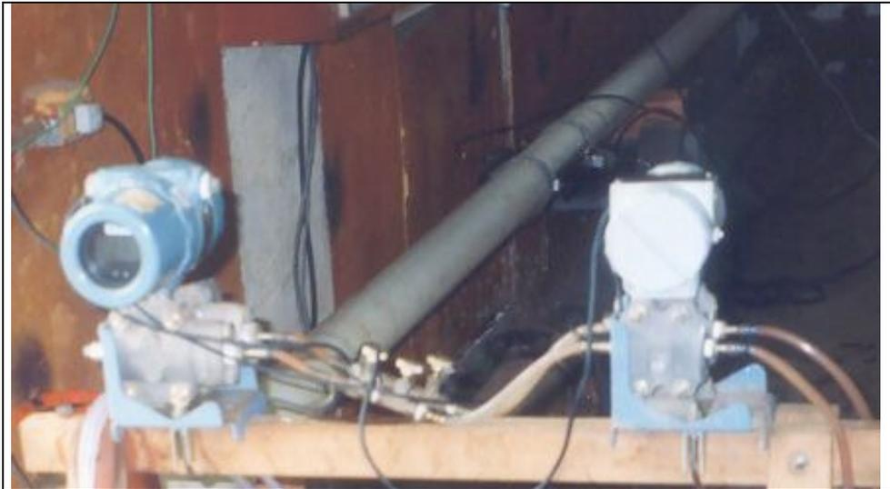
Figura 4.22 – Transdutores de pressão TP03 e TP01.
