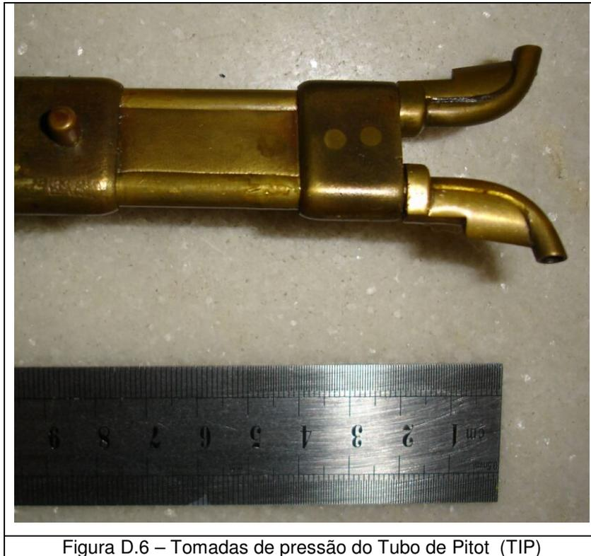
Figura D.6 – Tomadas de pressão do Tubo de Pitot (TIP)
