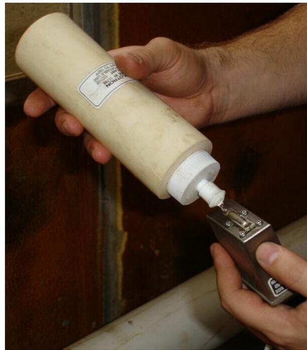
Figura 4.16 – Aplicação do gel na sonda do medidor.
