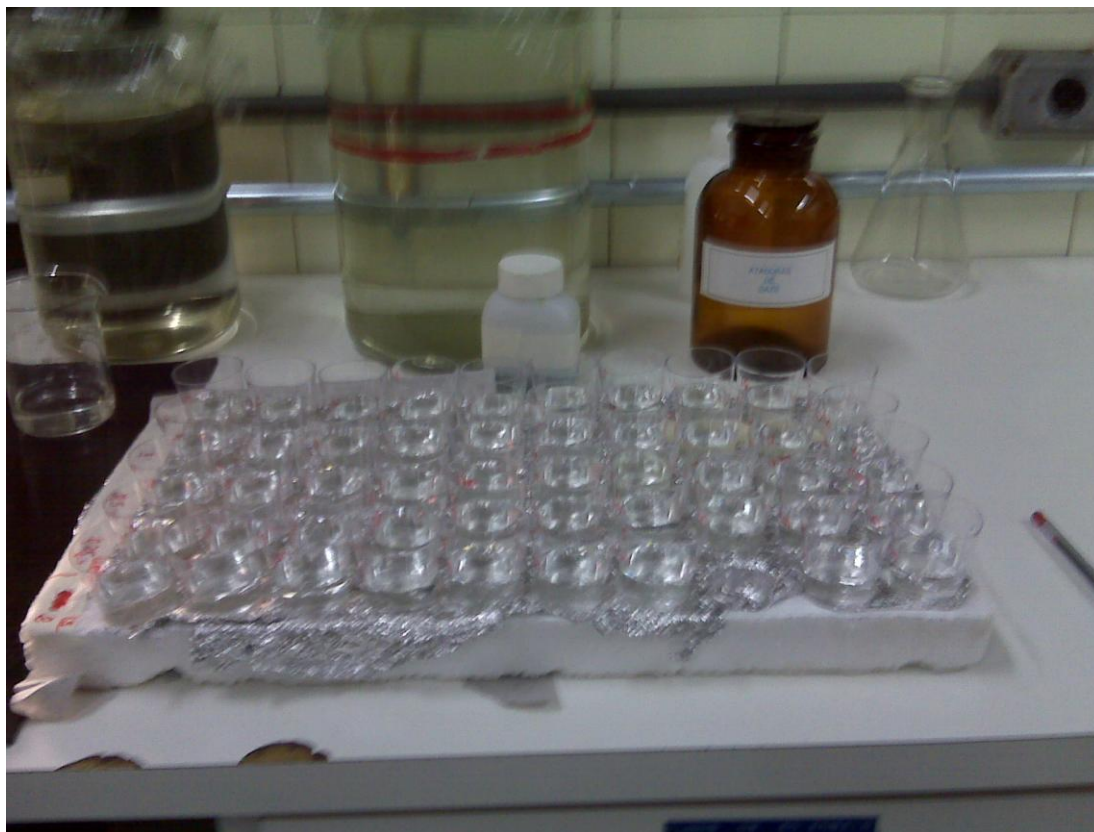
Figura 11 Montagem do ensaio de toxicidade aguda. Cada copo representa uma réplica
