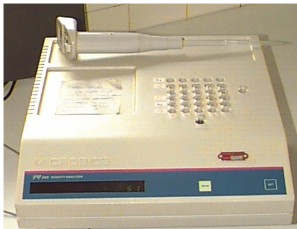
Figura 19 - Analisador de Toxicidade por fotoluminescência bacteriana - Modelo M 500 Microbics.
