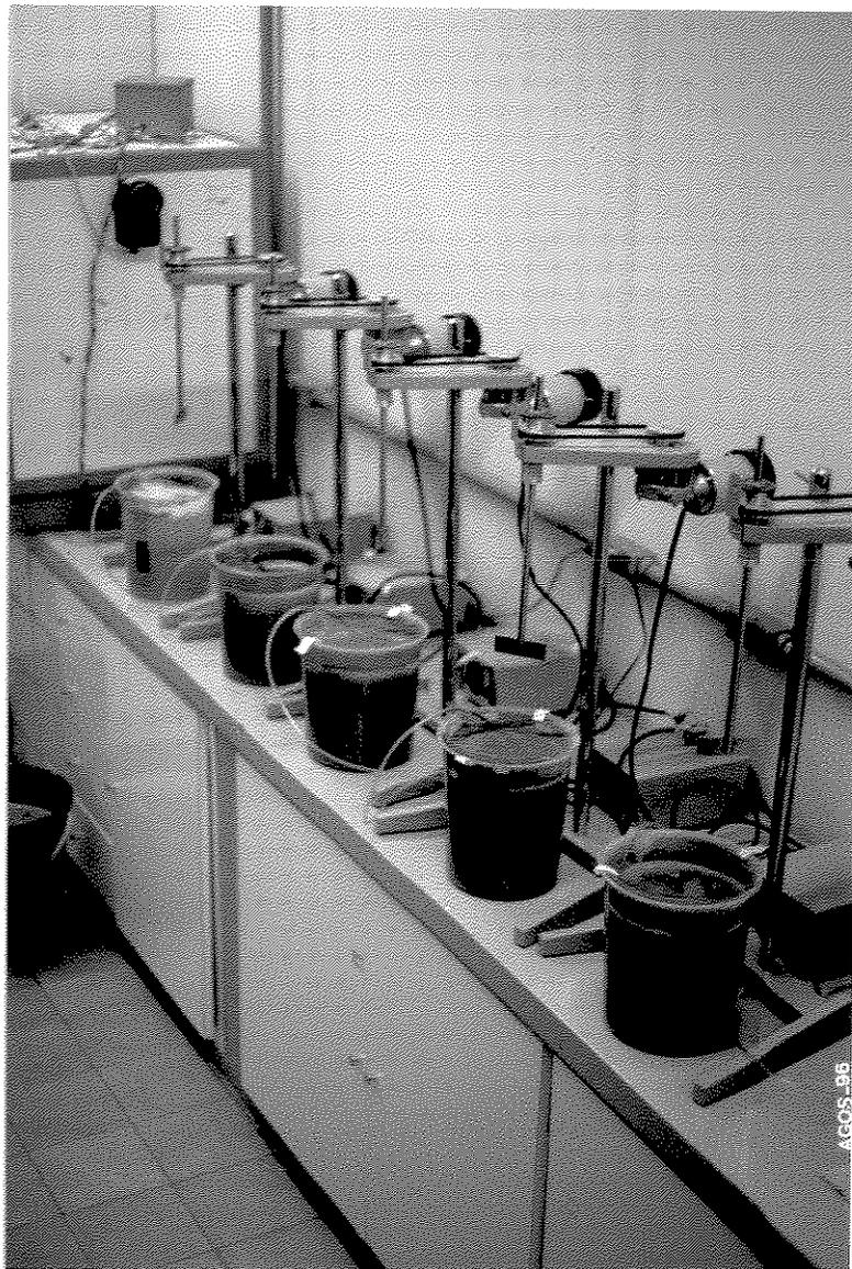
Figura 4.8 - Reatores tipo lodos ativados com fluxo intermitente, constituídos por béqueres.
