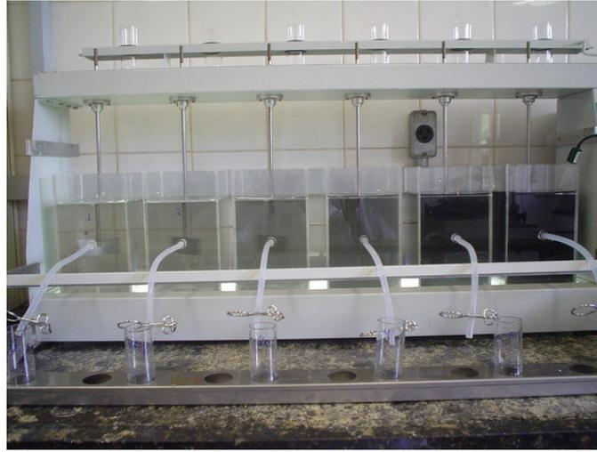
Figura 5.16: Fotografia do ensaio de “jar test” n° 27, denominado branco, com diferentes tonalidades, para variações nas dosagens de CAP iguais a 10, 20, 30, 50, 100 e 150 mg/L, da esquerda para a direita.
