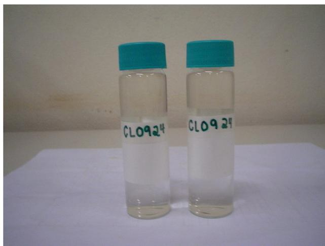
Figura 4.7: Foto ilustrando os frascos (“vials”) de 40 mL para coleta de amostras nas análises cromatográficas.
