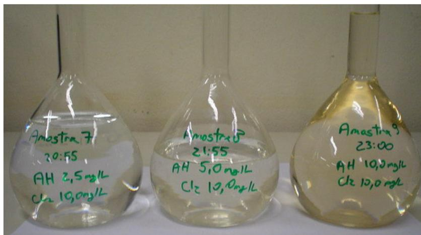
Figura 5.7: Foto dos reatores 7, 8 e 9 utilizados para as reações de oxidação com 10,0 mg/L de cloro e concentrações de ácidos húmicos respectivamente iguais a 2,5; 5,0 e 10,0 mg/L.
