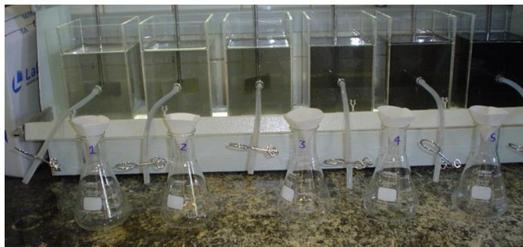
Figura 4.12: Frascos de vidro Erlenmayer para coleta de amostras filtradas para análise de trihalometanos.
