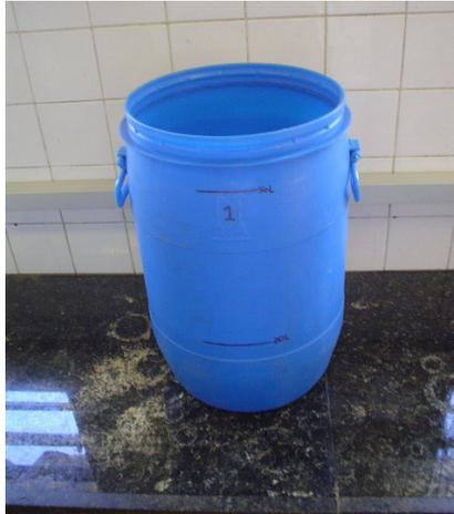
Figura 4.8: Foto da bombona plástica de 50 litros utilizada para coleta de água no poço e como reator de oxidação na etapa 3 da pesquisa.
