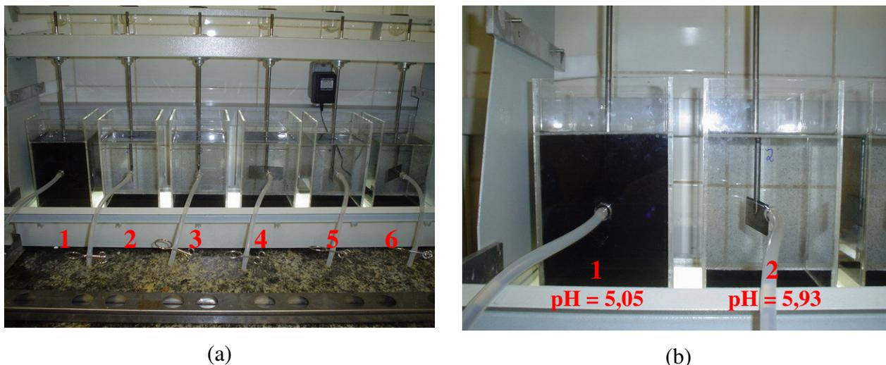
Figura 5.19: Fotografias da indicação do fenômeno de sedimentação de carvão ativado em pó para o ensaio nº 20, realizado na primeira fase.
