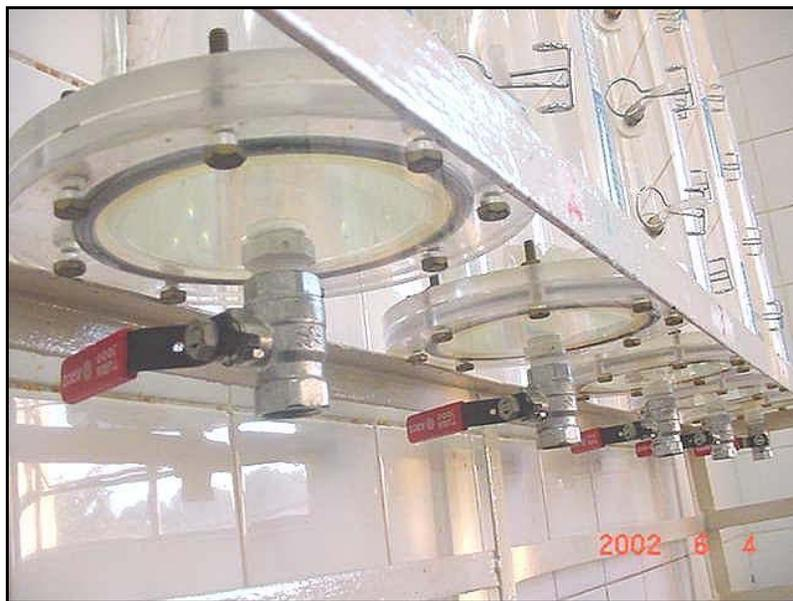
**Figura 4.12** – Descarga de fundo das colunas
