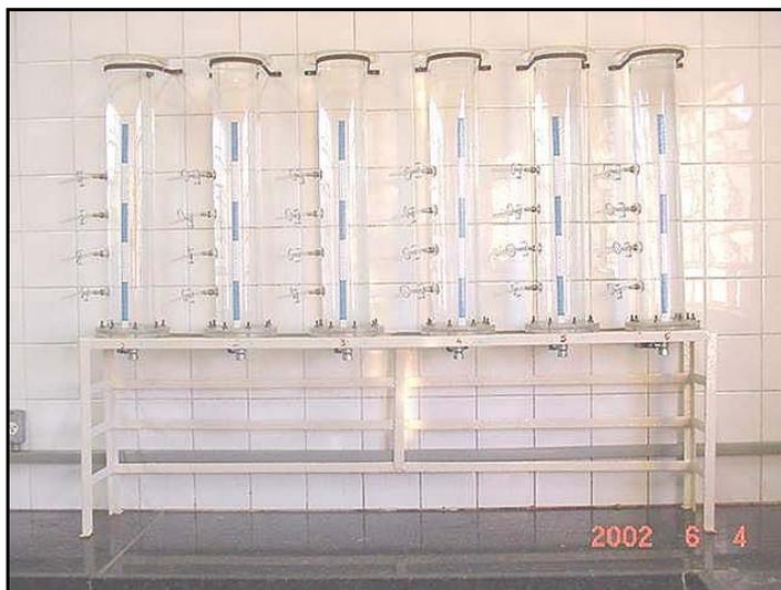
**Figura 4.9** – Sistema de bancada para realização dos ensaios de adensamento por gravidade
