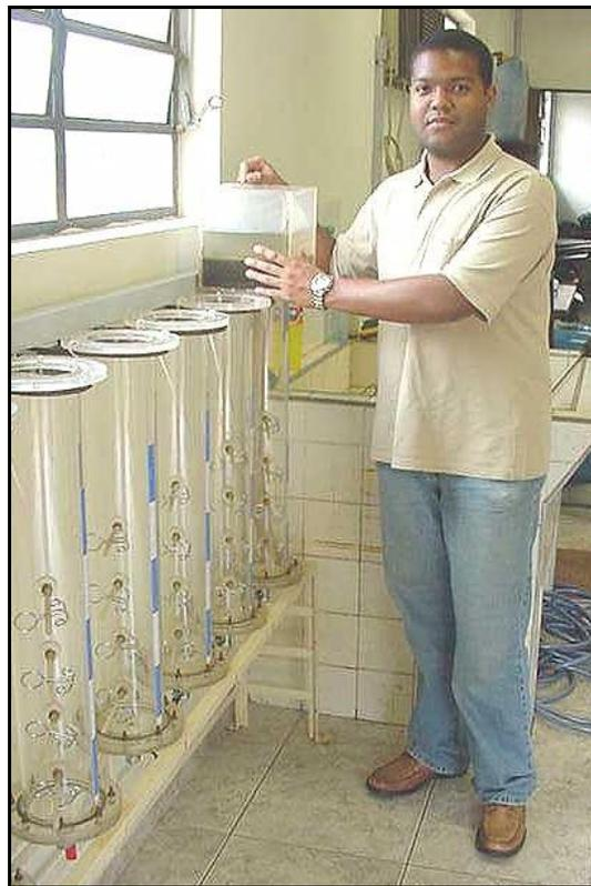
**Figura 4.8** – Transferência do lodo floculado para a coluna de sedimentação
