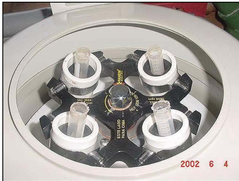
Figura 4.16 – Centrífuga de laboratório com alimentação por batelada.
