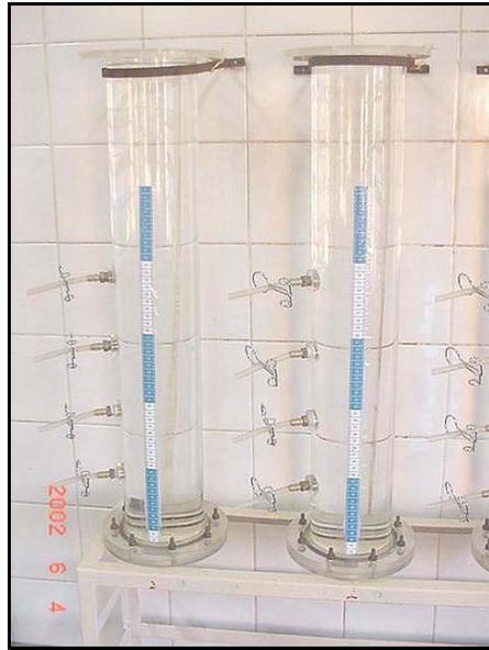
**Figura 4.10** – Colunas de sedimentação
