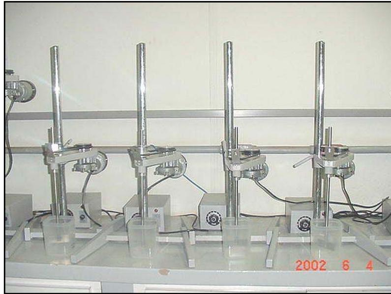
Figura 4.15 – Sistema de bancada para execução dos ensaios preliminares de desaguamento do lodo
