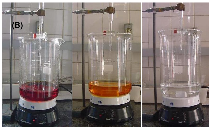
Figura 4.6 Arranjo experimental para medição do conteúdo de ozônio na corrente gasosa: (a) lavagem dos gases em solução de KI e (b) titulação com S_2O_3^{2-} .
