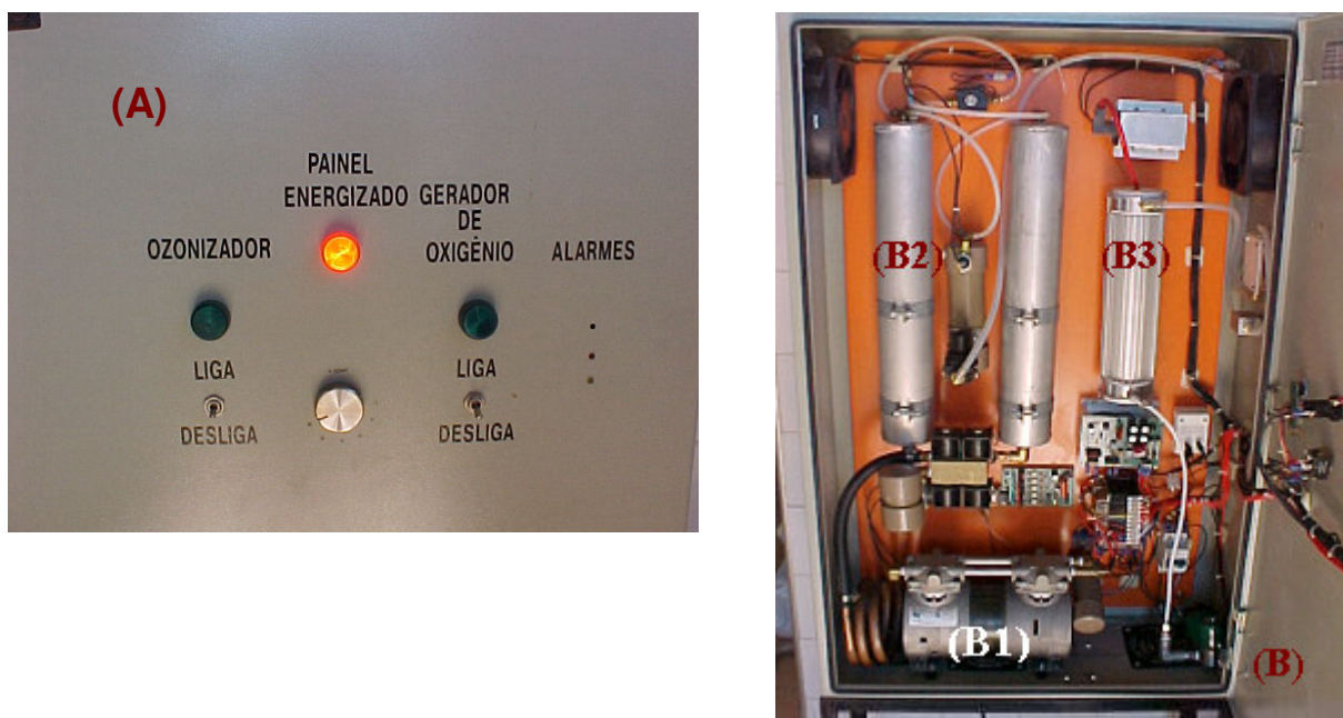
Figura 4.1 Detalhes do gerador de ozônio utilizado. (A) painel de controle, (B) vista interna: (B1) compressor de ar, (B2) peneiras moleculares (B3) gerador corona.
