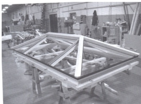
Figura 2.8: Montagem prévia das peças em CNC Fonte: Schodek (2005, p. 344)
