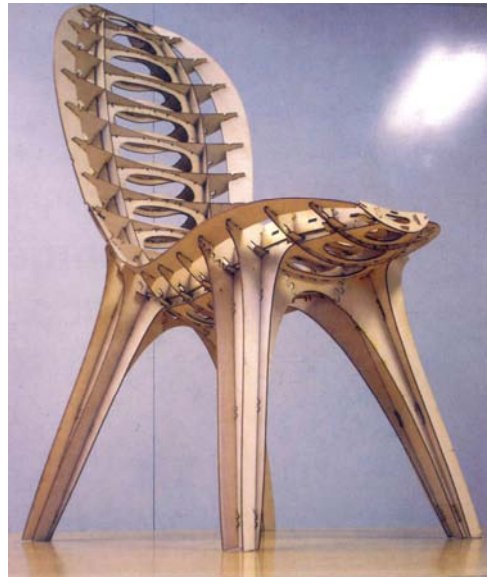
Figura 2.97: Cadeira produzida com técnicas de fabricação digital e montada manualmente Fonte: Pottmann et al (2007, p. 597)
