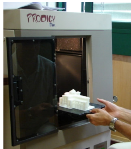
Figura 2.30: Produção direta 3D, de maquete, em equipamento Stratasys ProdigyPlus IST – Instituto Superior Técnico de Lisboa Foto: Regiane Pupo (2007)
