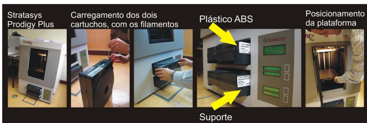
Figura 2.45: Preparação de equipamento Stratasys Prodigy Plus Fotos: Regiane Pupo
