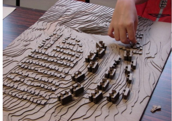
Figura 2.35: Maquete produzida em cortadora laser em papelão ondulado. FEC- Unicamp, 2008
