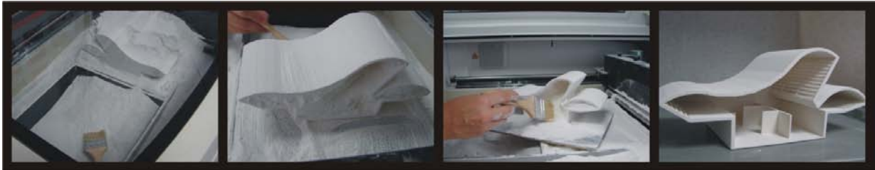
Figura 2.61: Gesso em pó como suporte no processo 3DP Fotos: Regiane Pupo
