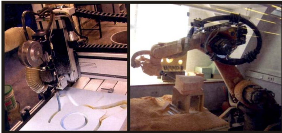
Figura 2.32: Desbaste de material em uma direção (esquerda) e em vários eixos (direita) Fonte: Pottmann et al (2007 p. 588)
