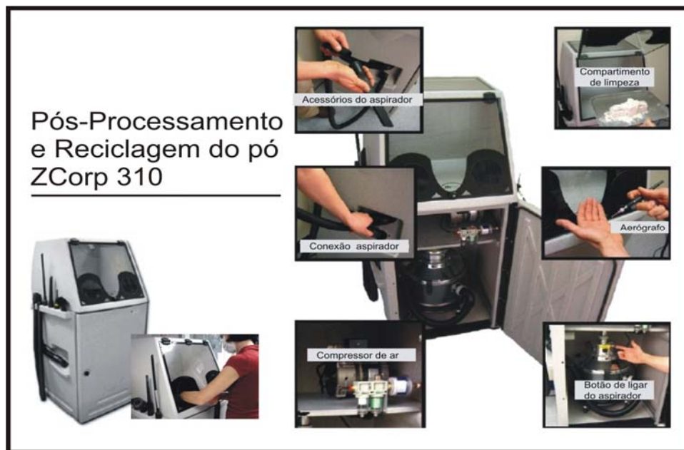
Figura 2.60: Pós-processamento do sistema 3DP Fonte: Adaptação de Manual ZCorp 310
