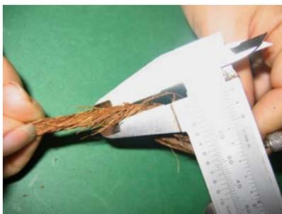
**Figura 4.18:** Detalhe da medição do diâmetro do conjunto de fibras da casca de coco verde, com paquímetro.
