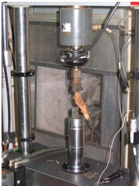
**Figura 4.17: Detalhe da preparação do ensaio de tração com as fibras da casca de coco verde no servohidráulico para ensaios mecânicos (Modelo: 810-TestStarII, Fabricante: MTS - Material Testing System).**
