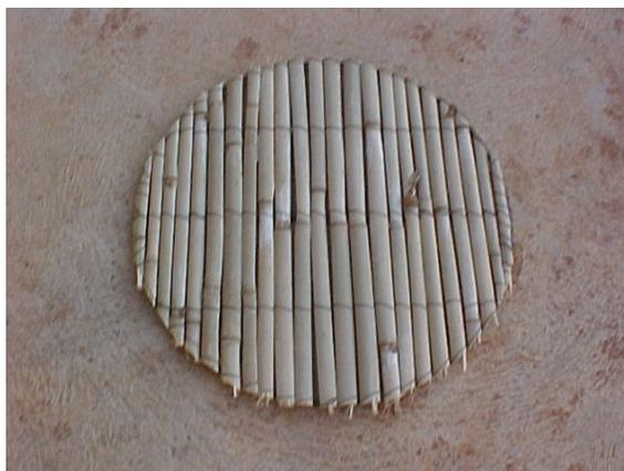
**Figura 4.5: Grade suporte de bambu, instalada no fundo dos reatores, sobre o cone e na superfície.**
