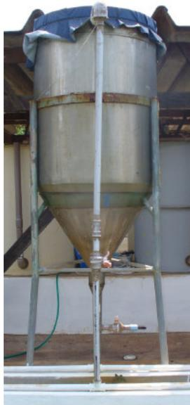
Figura 4.8: Vista frontal do reator anaeróbio com recheio de coco verde.
