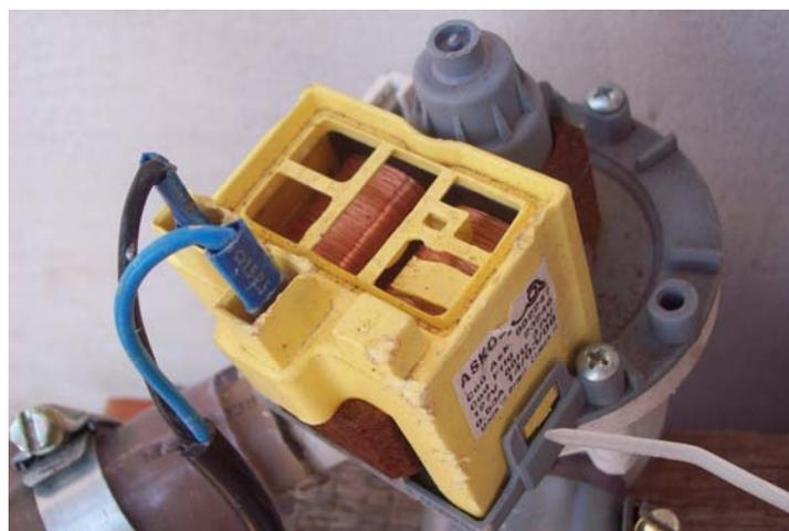
Figura 4.12: Detalhe da bomba que recalca efluente anaeróbico para filtros de areia.
