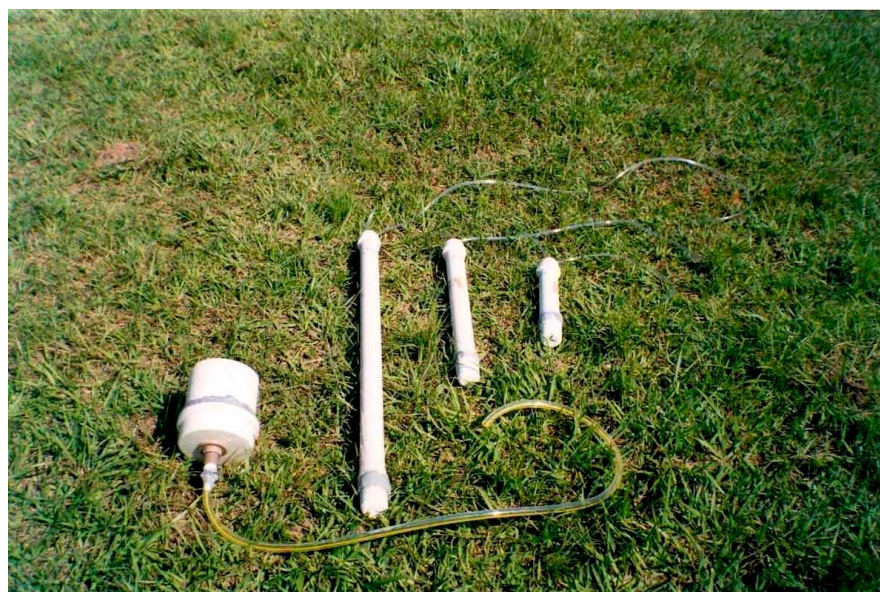
Fig. 5 - Caixa coletora e lisímetros de sucção usado para coletar de amostras do efluente percolado.
