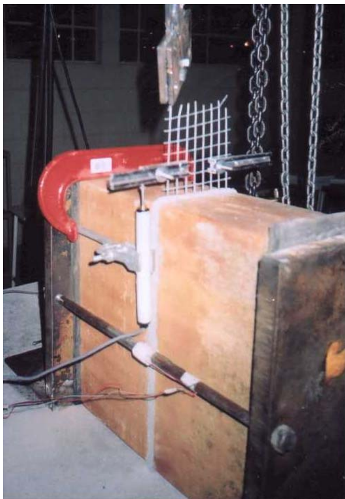
Figura 5.5 – Instante do Escoamento da Tela Metálica.
