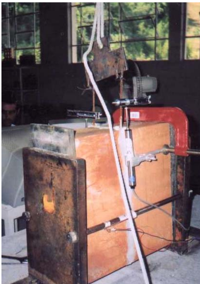
Figura 5.3 – Instante do Arrancamento da Barra de Aço CA-50 5,0 mm do Prisma de Alvenaria.
