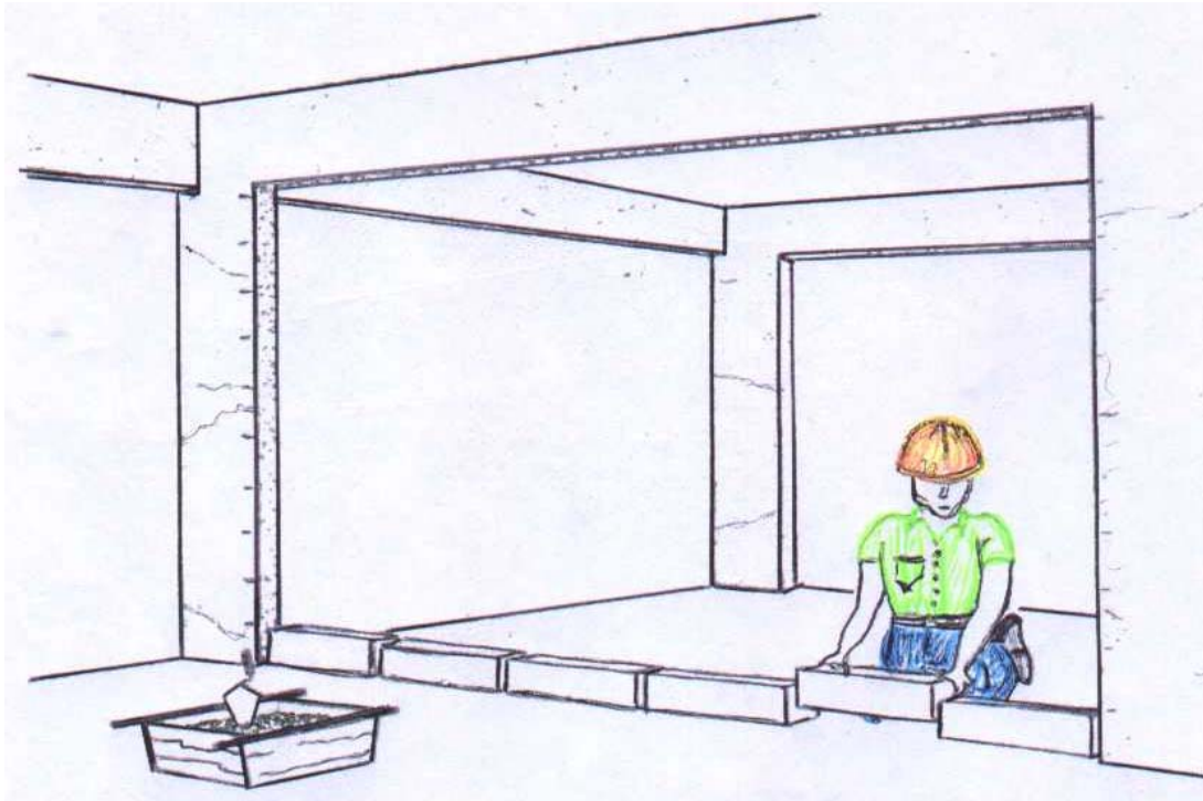
Figura 2.12 – Definição do Espaçamento dos Blocos na Fiada de Demarcação (Franco, Barros e Sabbatini, 1994).
