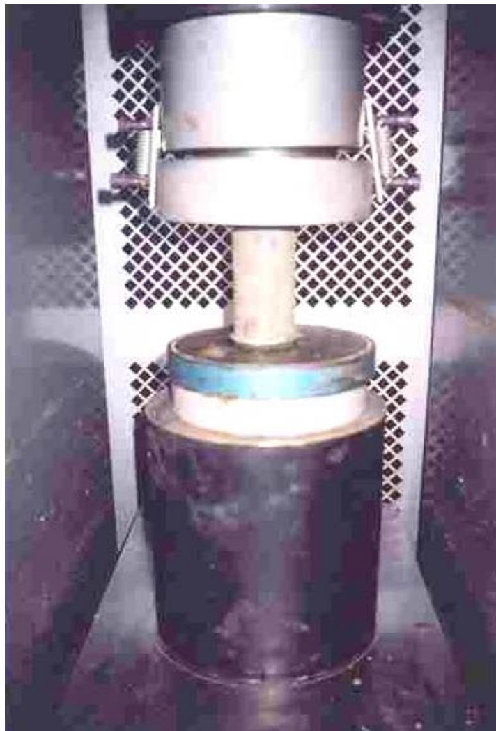
Figura 4.9 – Ensaio da Resistência à Compressão do Cimento Portland.
