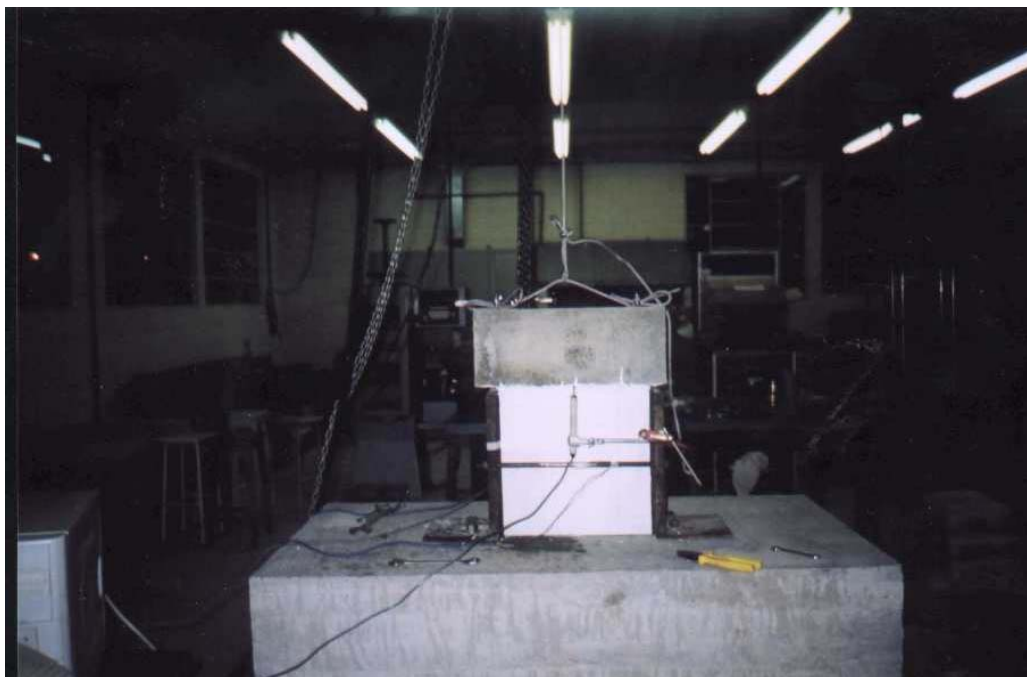
Figura 3.6 – Equipamento do Ensaio de Arrancamento do Dispositivo Fixado ao Pilarete de Concreto Armado e à Junta de Argamassa de Prismas de Alvenaria.
