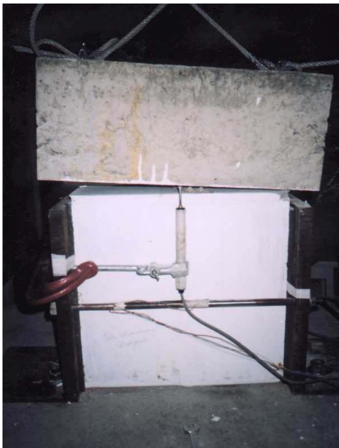
Figura 5.10 – Detalhe da Ruptura do Corpo-de-Prova Sem Tratamento.
