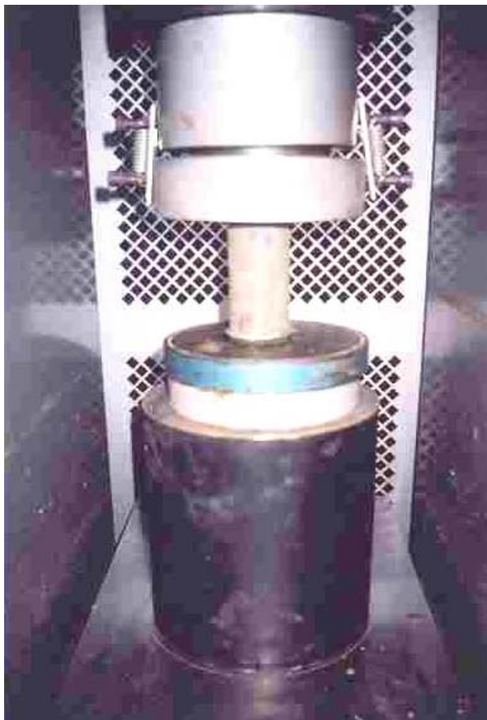
Figura 4.2 – Ensaio da Resistência à Compressão da Argamassa de Assentamento.
