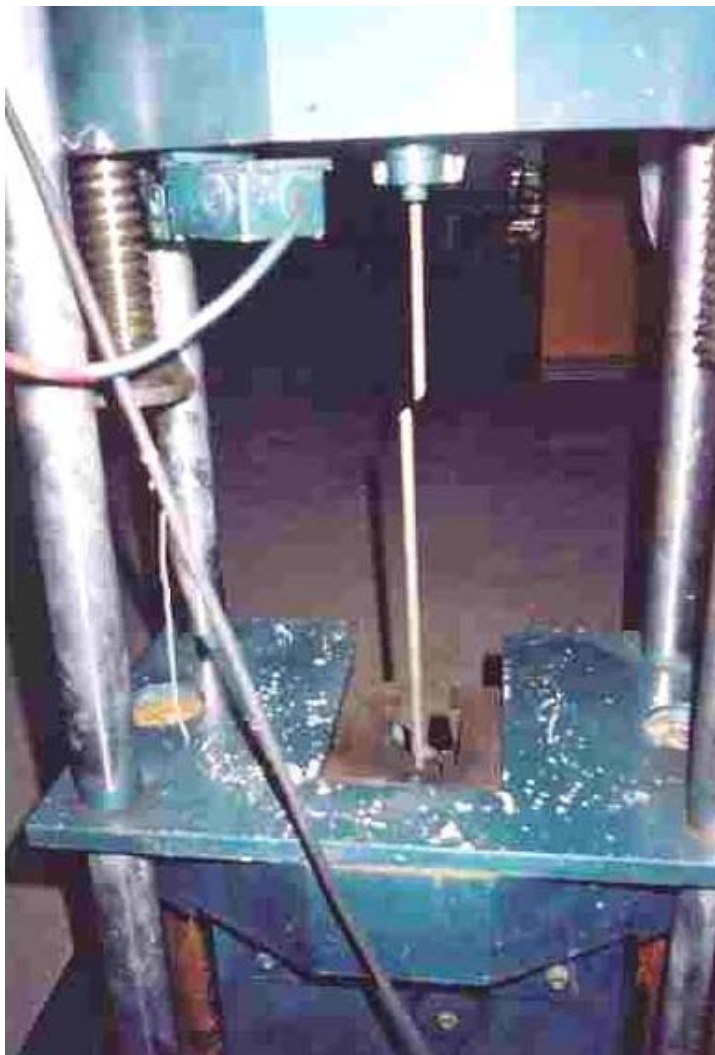
Figura 4.6 – Ensaio da Resistência à Tração das Barras de Aço.
