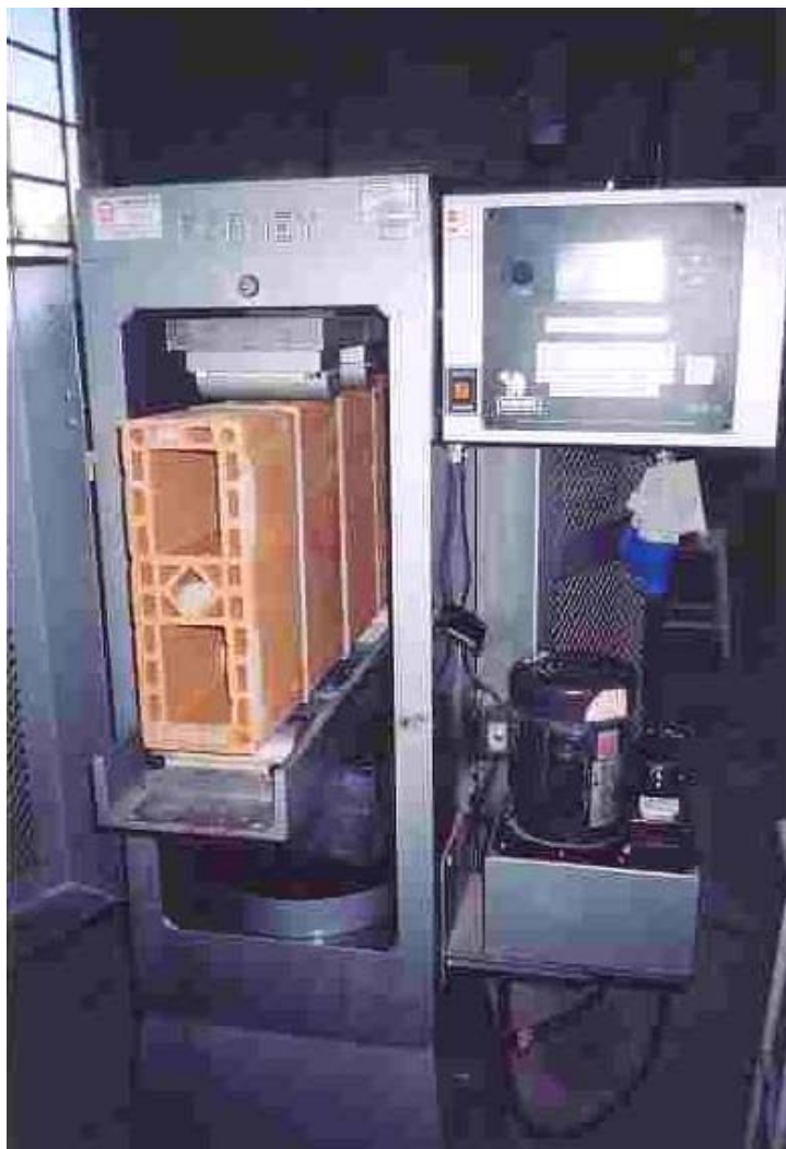
Figura 4.3 – Ensaio da Resistência de Aderência à Flexão da Argamassa de Assentamento.
