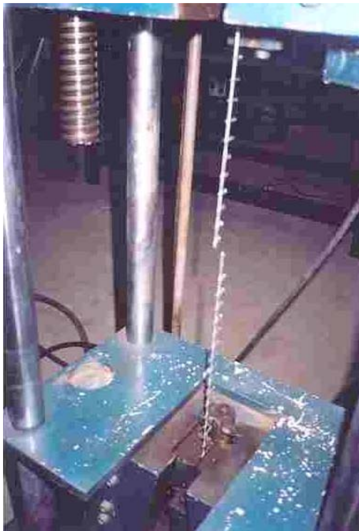
Figura 4.8 – Ensaio da Resistência à Tração da Tela Metálica Eletrosoldada.
