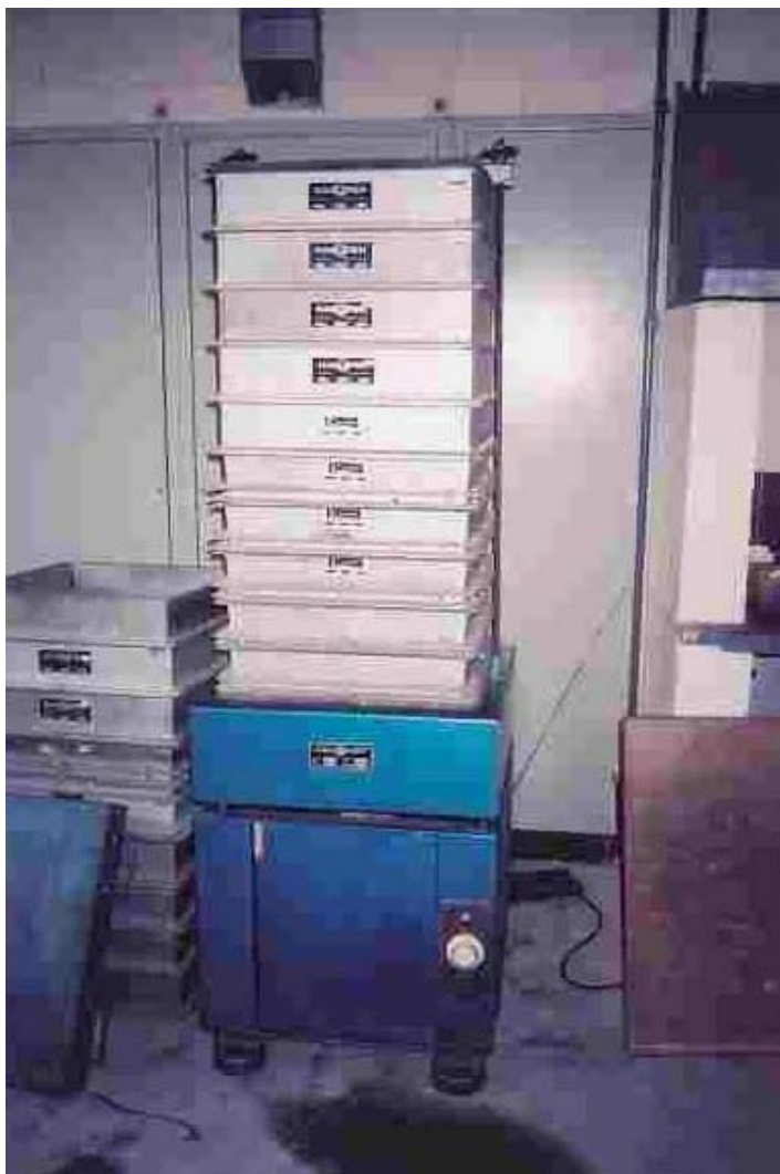
Figura 4.11 – Ensaio da Determinação da Composição Granulométrica do Agregado Graúdo.
