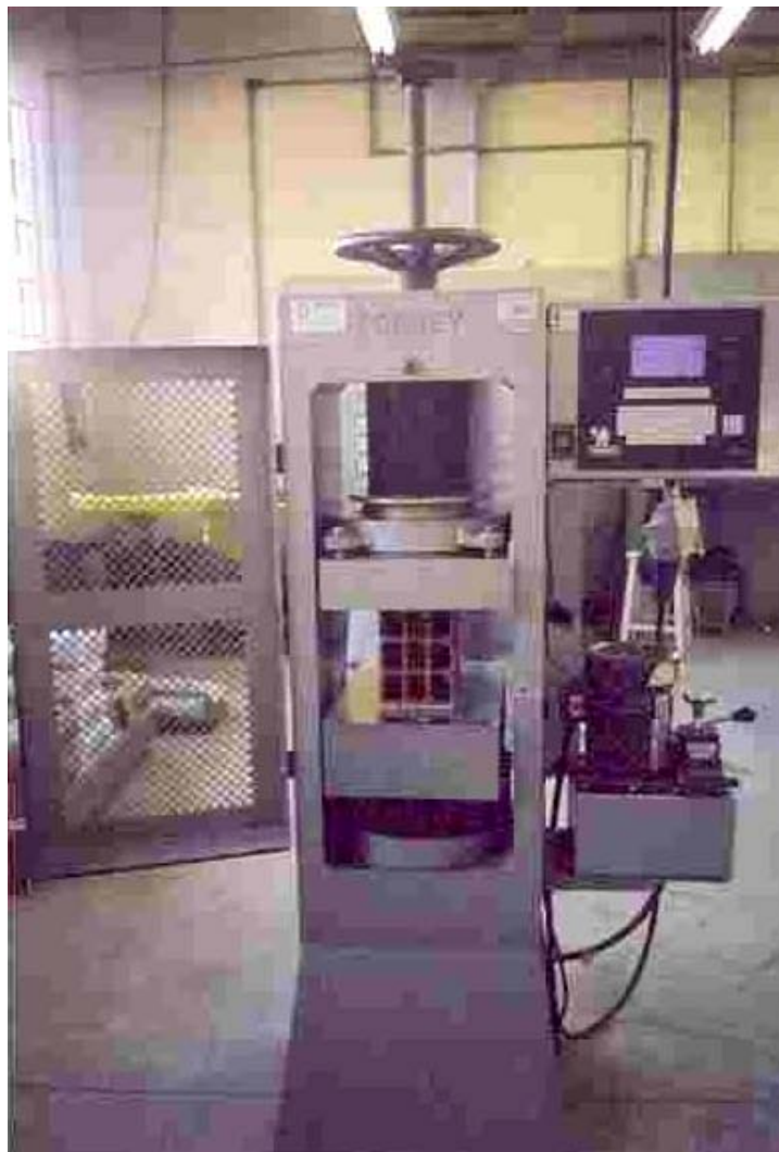
Figura 4.1 – Ensaio da Resistência à Compressão do Tijolo Cerâmico Tipo “A”.
