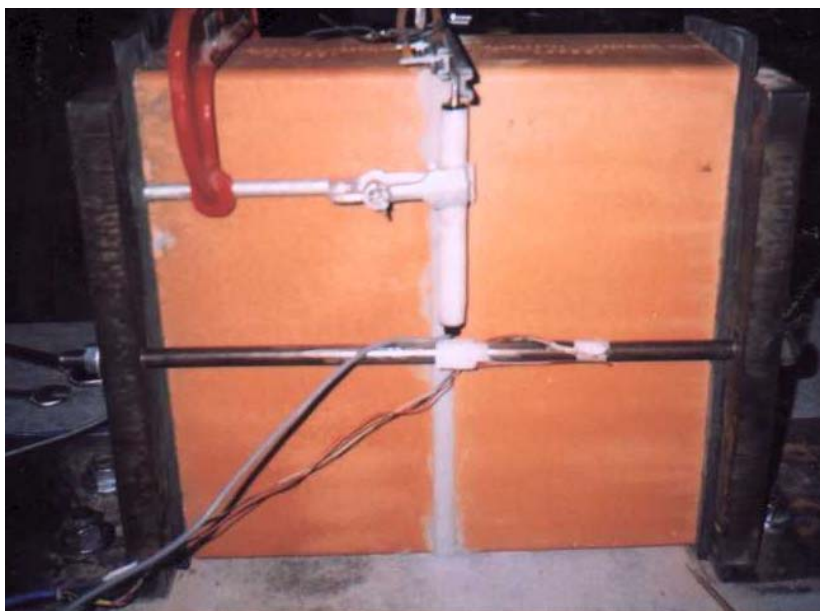
Figura 4.17 – Ensaio de Arrancamento para o Aço CA-50, diâmetro 6,3 mm e comprimento de ancoragem 40 cm.
