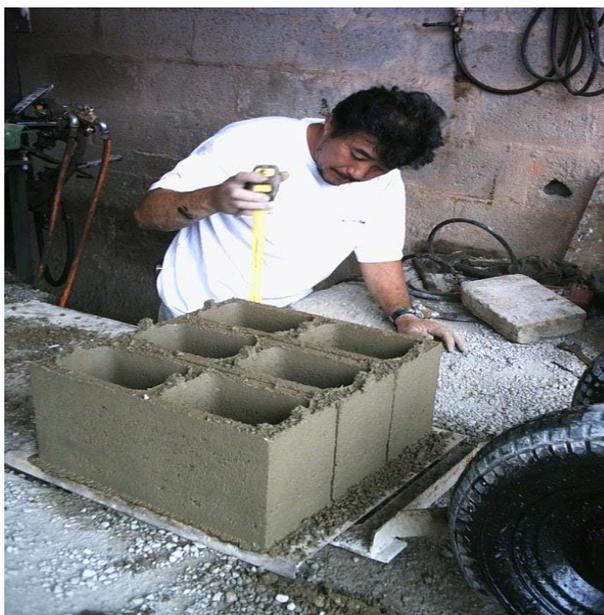
Figura 8.4: blocos de concreto com GRAP (2004)<sup>10</sup>
