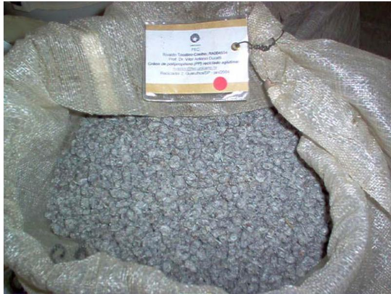
Figura 6.2: grãos reciclados aglutinados de polipropileno – GRAP
