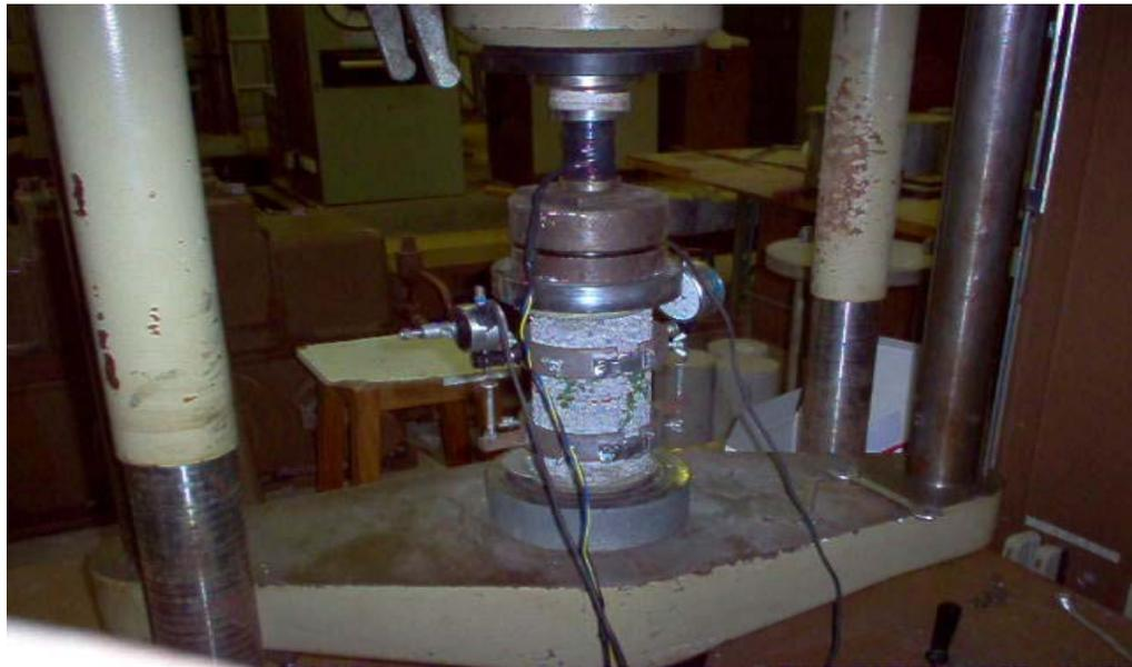
Figura 6.14: Instrumentação para o ensaio do módulo de elasticidade secante
