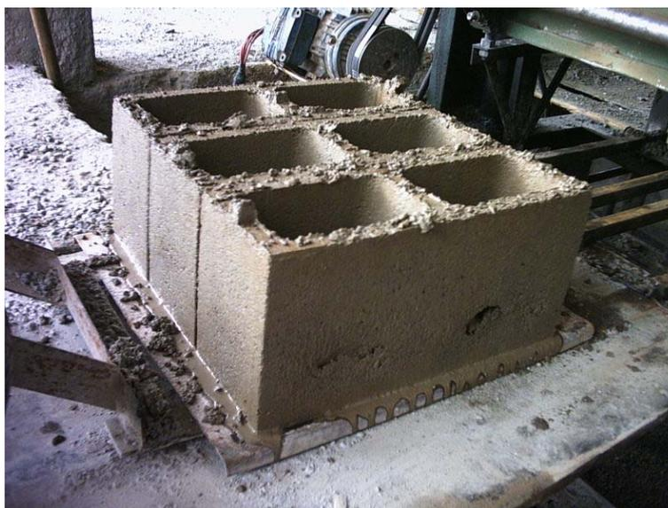
Figura 8.2: Blocos de concreto: 1ª. Tentativa de fabricação dos blocos
