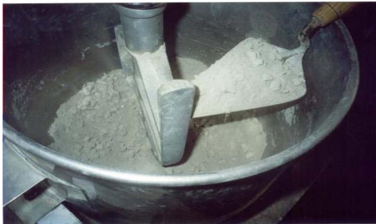
Figura 6.3: Mistura dos materiais na argamassadeira
