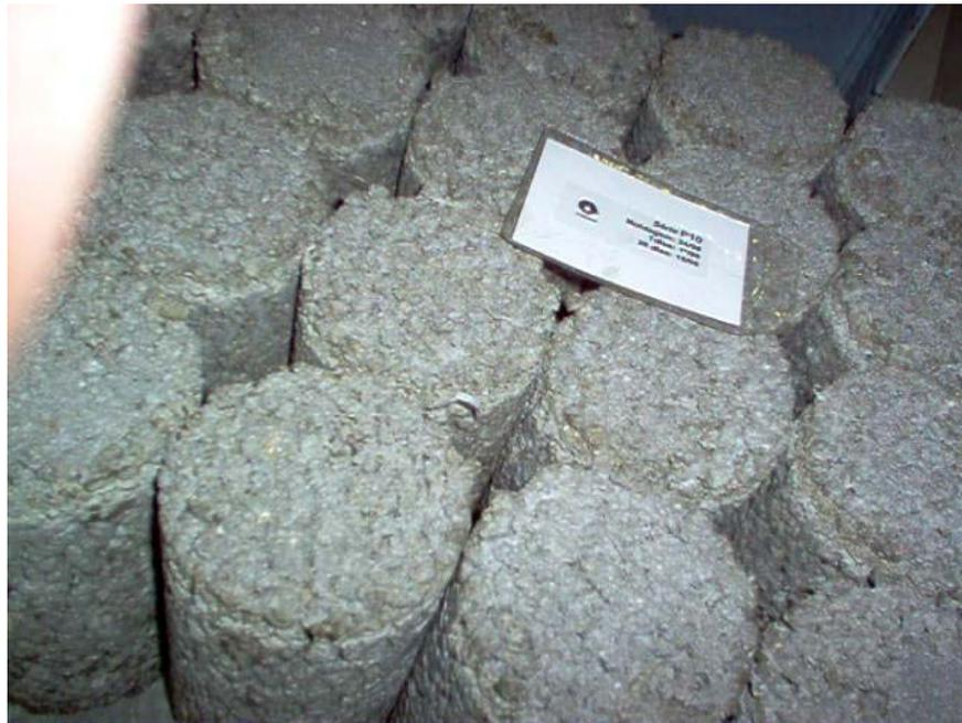
Figura 6.7: Corpos-de-prova cilíndricos da Série A, tipo P10.
