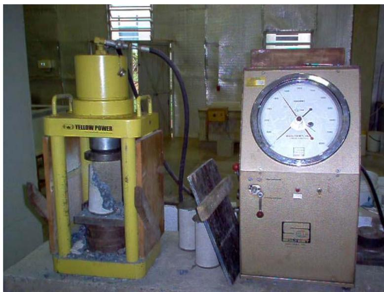
Figura 6.12: Determinação das resistências à compressão diametral e axial
