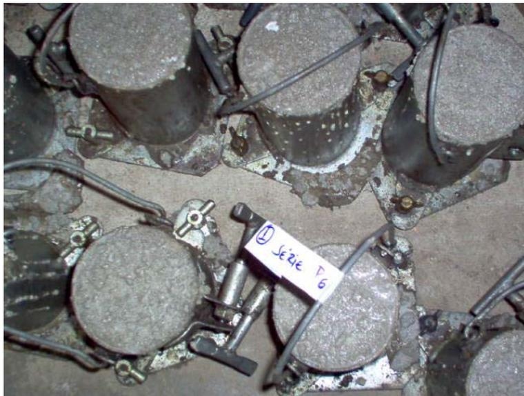
Figura 6.5: moldagem dos corpos-de-prova cilíndricos
