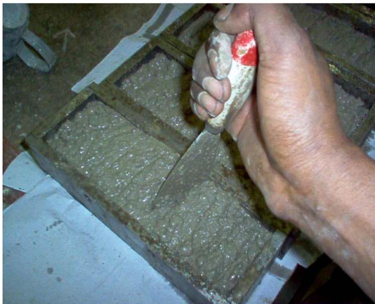
Figura 6.4: Moldagem dos corpos-de-prova cúbicos
