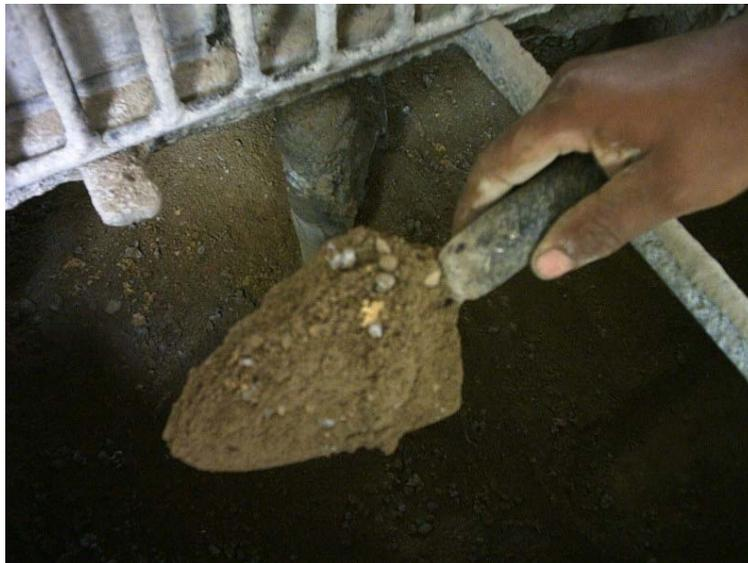
Figura 8.1: Preparação da mistura para a produção de blocos com GRAP
