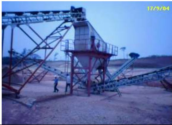
**Figura FD 9** Transportadores : móvel e fixo.
