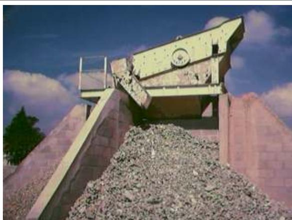
**Figura FA9** Peneira apoiada em alvenaria.
