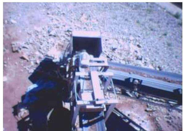
**Figura FA6** Eletroimã posicionado acima da correia transportadora.
