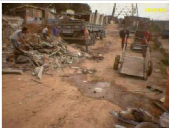
**Figura FC7** Material retirado da matéria-prima durante a etapa de triagem.
