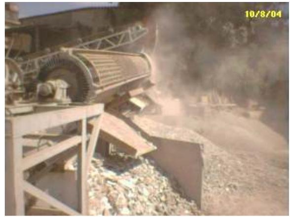
**Figura FC16** Classificação granulométrica do material reciclado.
