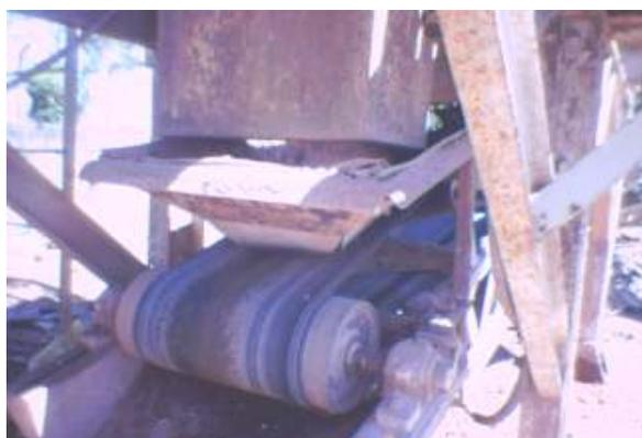
**Figura FA7** Saída do material britado.
