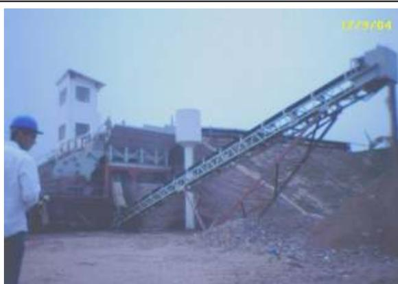
**Figura FD7** Transportador fixo : produção de material originado do escalpe.
