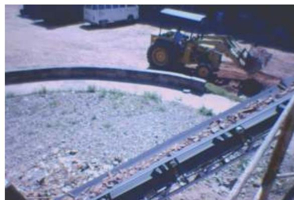
**Figura FA8** Guia em concreto para locomoção do transportador de correia.
