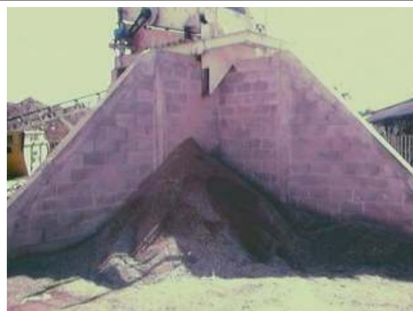
**Figura FA10** Classificação dos agregados e suas baias.
