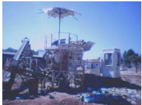
**Figura FA4** Equipamentos : britador, separador magnético e transportador.
