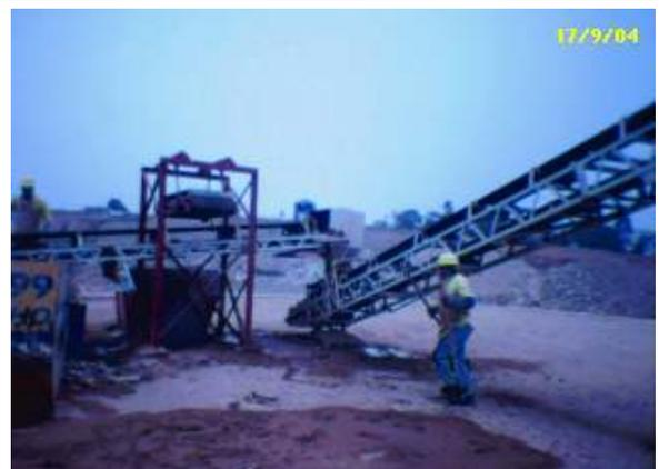
**Figura FD6** Transportador: mudança de direção. Separador magnético.
