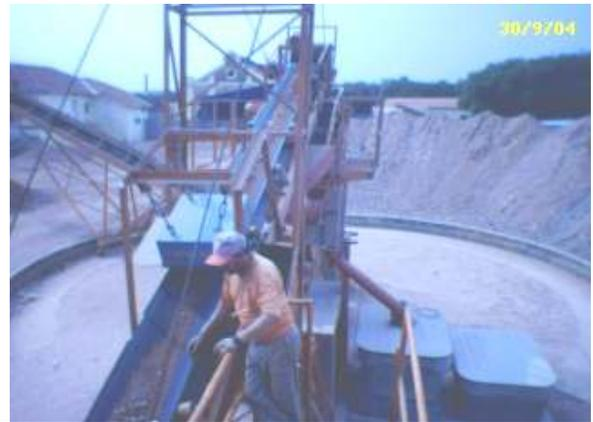
**Figura FE6** Equipamento: vista superior. Separador magnético.
