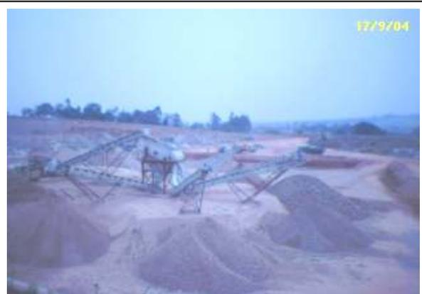
**Figura FD8** Peneiras, transportadores fixos e empilhamento dos agregados.
