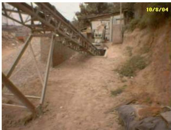
**Figura FC11** Transportadores de correia apoiado em estrutura metálica.
