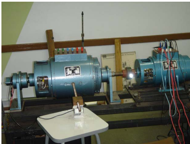
Figura 4.1: Arranjo de ensaio com freio eletrodinamométrico
