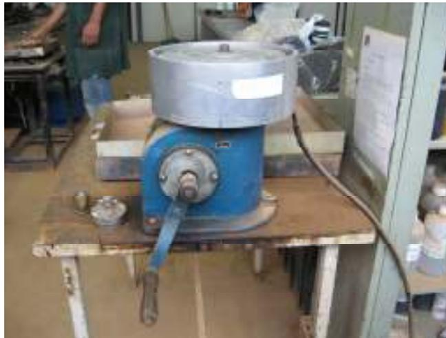
Figura 3.15- Equipamento rotarex durante o ensaio.
