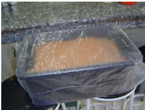
Figura 3.7- Recipiente com os corpos de prova, envolvido com plástico.
