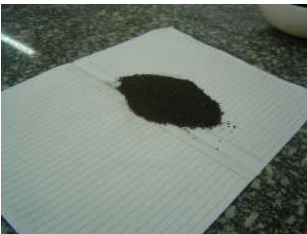
Figura 3.11- Material fresado usado para o peneiramento fino.
