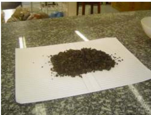
Figura 3.10- Material fresado usado para o peneiramento grosso.
