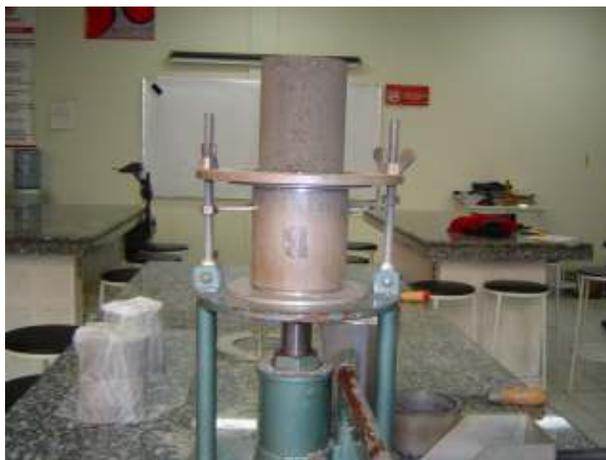
Figura 3.3- Corpo de prova sendo desmoldado em um extrator hidráulico.
