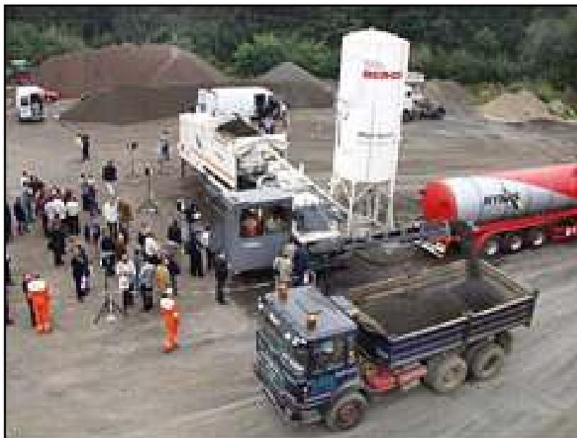
Figura 2.16- *Mobile mixing plant* KMA 200. Fonte: Wirtgen América (2006).
