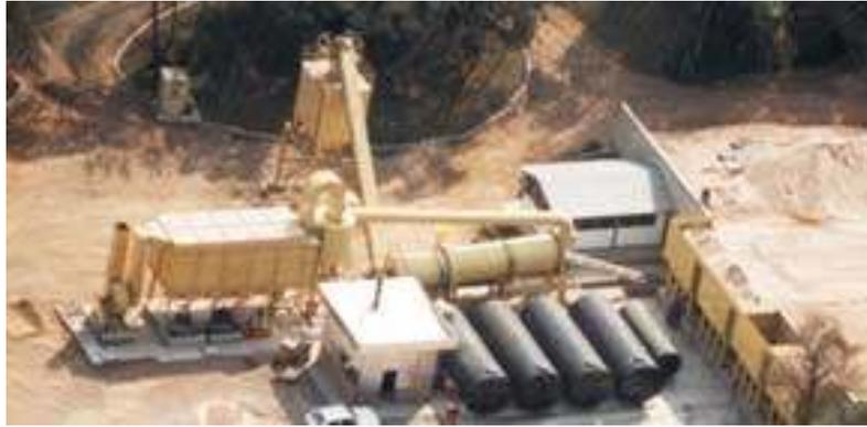
Figura 2.15- Usina *Drum Mixer* – Cifali. Fonte Trimak (2006).
