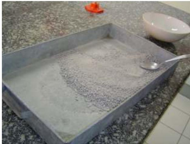
Figura 3.1- Amostra de brita graduada passada na peneira 0,0048 m.
