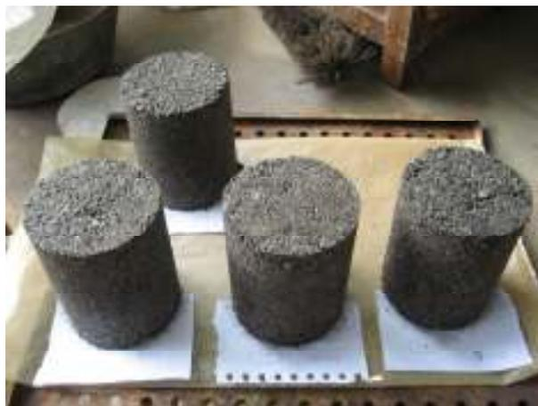
Figura 3.24- Corpos de prova após desmoldagem.
