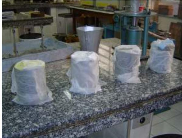
Figura 3.5- Corpos de prova envolvidos com papel-toalha umedecido.
