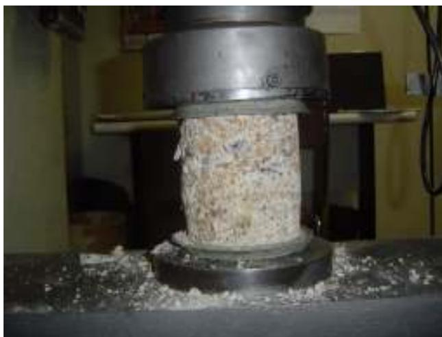
Figura 3.14- Ruptura do corpo de prova na prensa.
