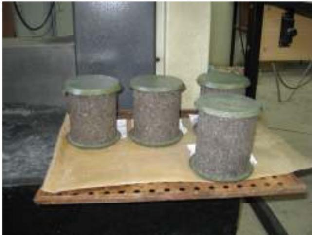
Figura 3.25- Corpos de prova capeados.
