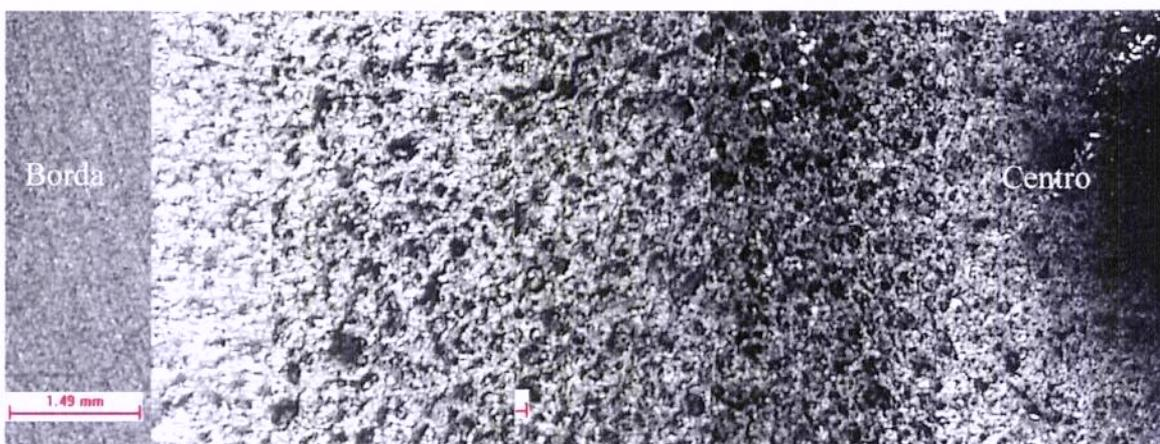
Foto 6.3. Efeito da cavitação, em amostra de alumínio.
