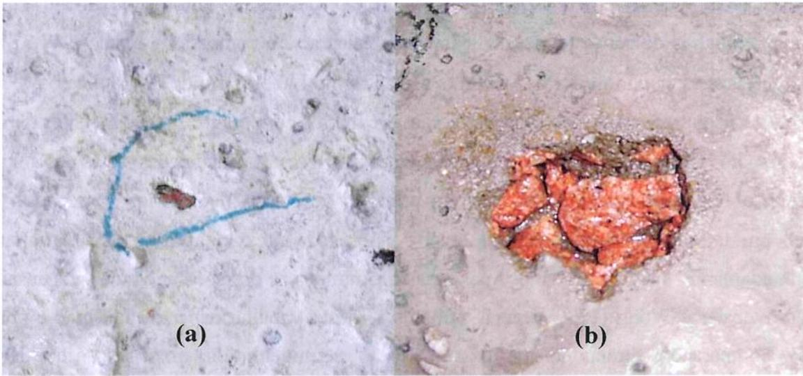
Foto 6.11. Erosão em concretos: (a) jato livre; (b) jato submerso.
