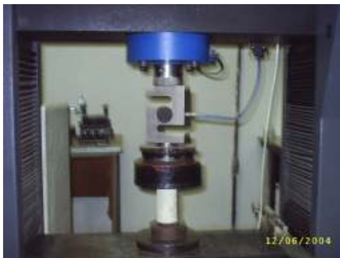
Figura 14 Ensaio de resistência à compressão.
