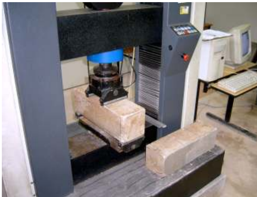
Figura 15 Ensaio de resistência à tração na flexão.
