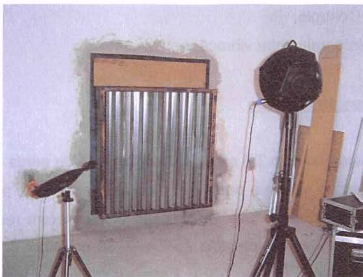
Figura 7-7. Sala de teste com a fonte que gera o ruído branco. Ao fundo Atenuador Instalado para teste com 12 lamelas de espessura de 50 mm.
