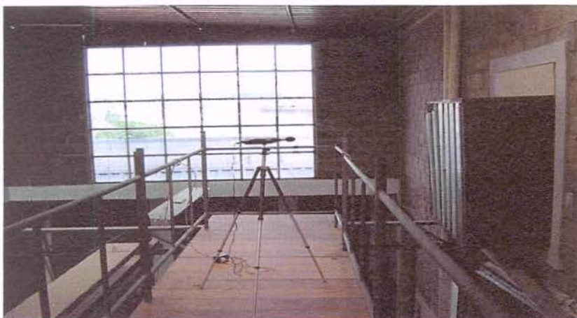
Foto 1 Passarela montada para realização das medições no Galpão receptor com medidor de nível de pressão sonora, posicionado no ponto 4 , a 05 metros de altura durante medição.
