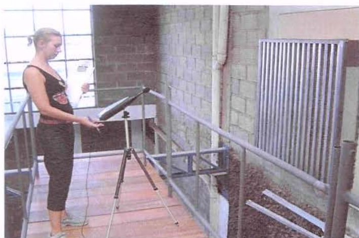
Foto 3 Durante Medição do Nível de Pressão Sonora de um dos Atenuadores
