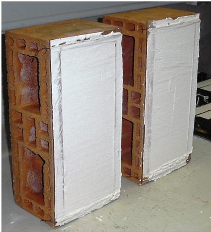
Figura 4.60 – Blocos cerâmicos de alvenaria depois da aplicação das pastas de gesso comercial como revestimento (Bloco esquerdo – GC1, Bloco direito GC2).
