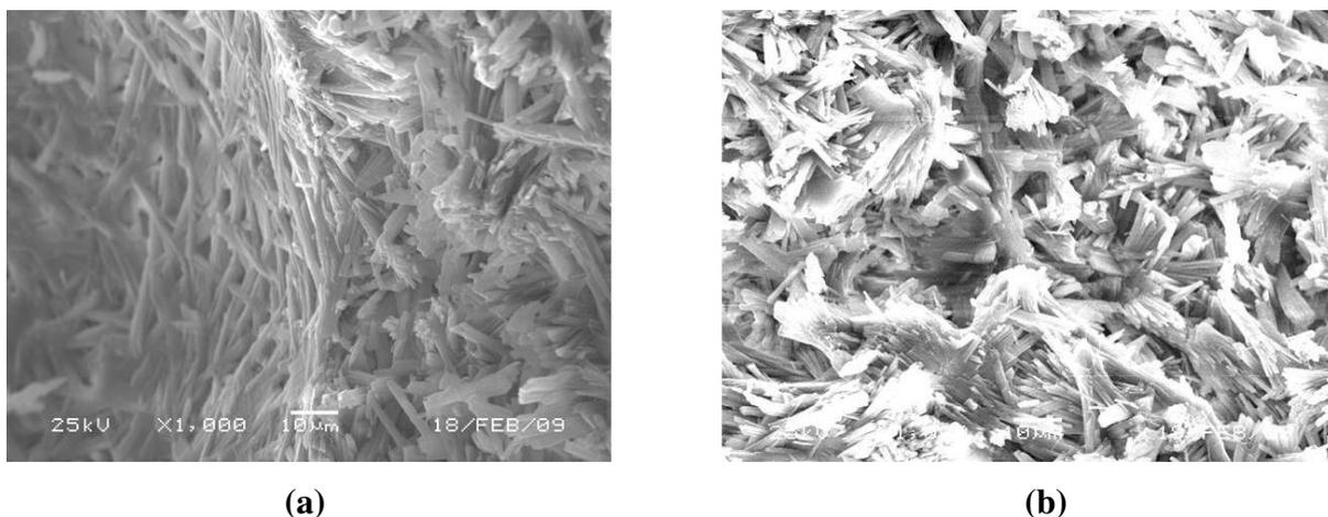
Figura 4.42 – Microscopia – 28 dias – Pastas de relação água/gesso 0,53 – Ampliação 1000 vezes - GC1 (a) e GC2 (b).
