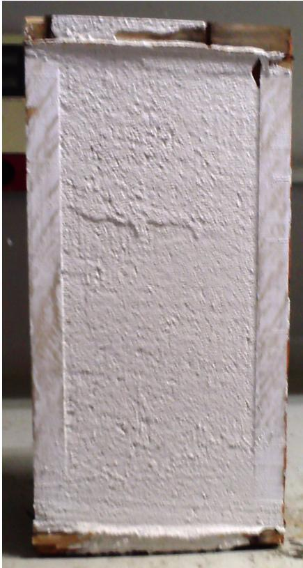
Figura 4.67 – Bloco cerâmico de alvenaria estrutural depois da aplicação de revestimento de pasta de gesso reciclado grosso calcinado a 200 °C.
