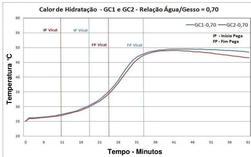
Figura 4.9 – Curva de Evolução de Temperatura - Gesso Comercial (GC1 e GC2) - Rel. água/Gesso = 0,70.
