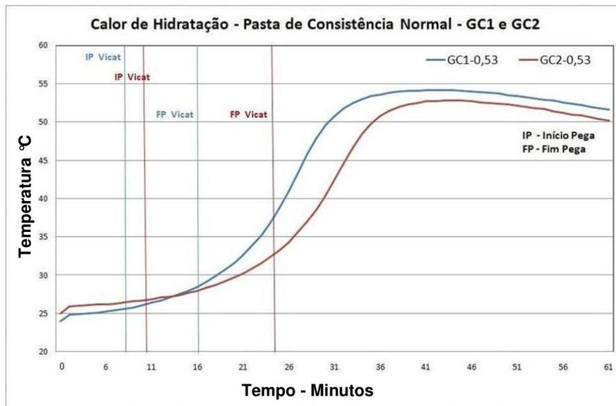
Figura 4.13 – Curva de Evolução de Temperatura - Gesso Comercial (GC1 e GC2). Pasta de Consistência Normal.
