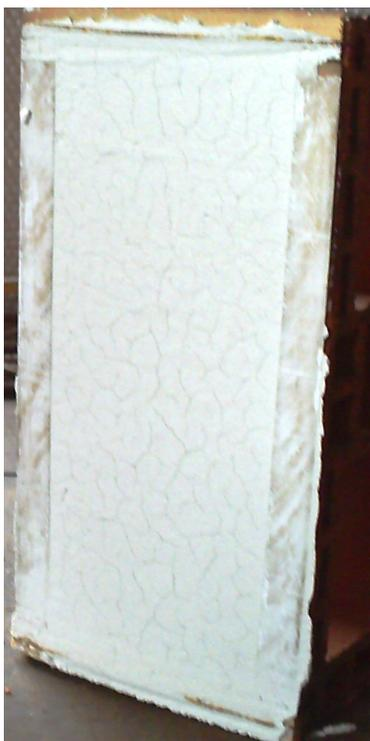
Figura 4.69 – Bloco cerâmico de alvenaria depois da aplicação de revestimento de pasta de gesso reciclado fino calcinado a 200 °C.
