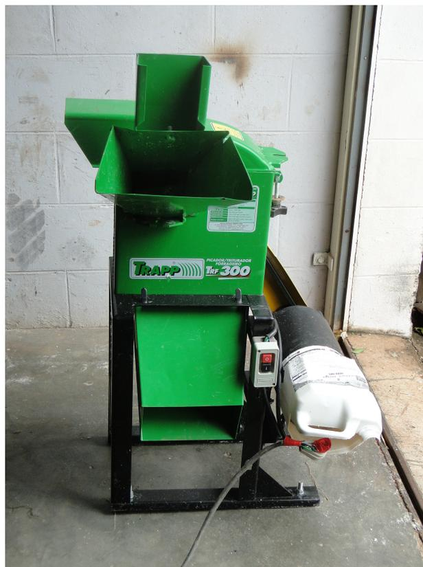
Figura 3.3 – Equipamento utilizado para a moagem do gesso residual – Picador/Triturador/Forageiro: TRAPP/TRF 300.
