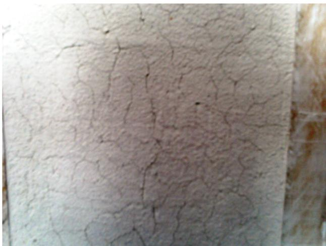
Figura 4.70 - Detalhes de fissuras de retração em revestimento de pasta de gesso reciclado fino calcinado a 200 °C.
