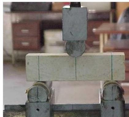
Figura 3.8 – Ensaio de resistência à tração na flexão em corpo de prova prismático de 40x40x160 mm.
