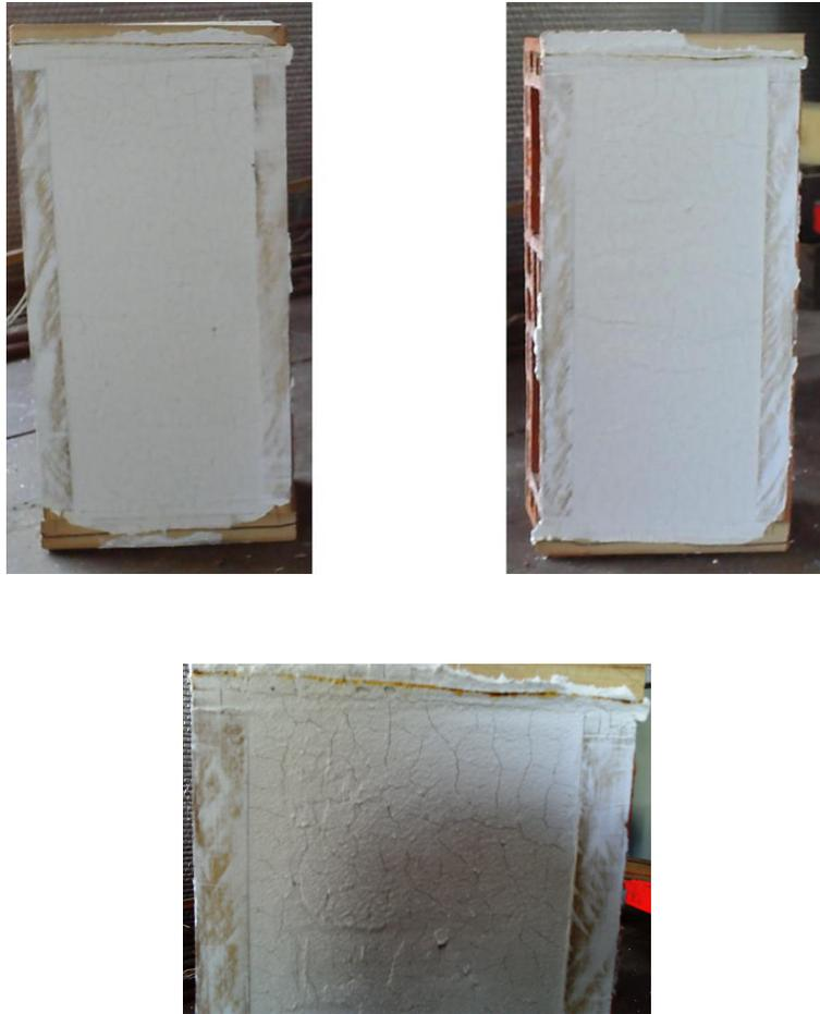
Figura 4.64– Blocos cerâmicos de alvenaria estrutural depois da aplicação de revestimento de pasta de gesso reciclado grosso calcinado a 180 °C.
