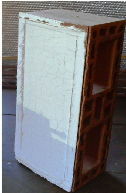
Figura 4.62 – Bloco cerâmico de alvenaria estrutural depois da aplicação do revestimento de pasta de gesso reciclado fino calcinado a 150 °C.
