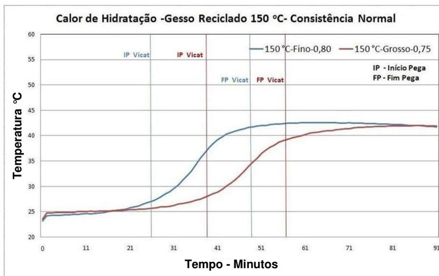
Figura 4.14 – Curva de Evolução de Temperatura - Gesso Reciclado 150 °C. Pasta de Consistência Normal.
