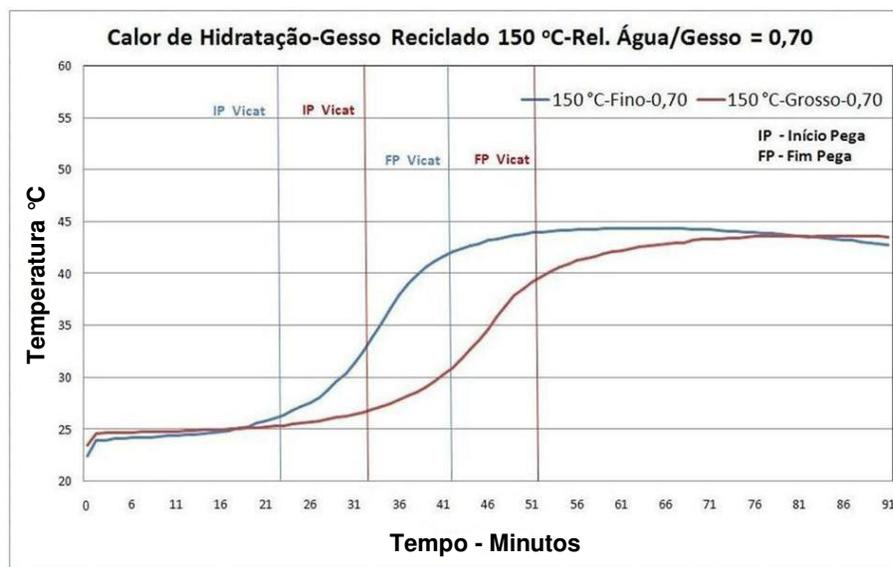
Figura 4.10 – Curva de Evolução de Temperatura - Gesso Reciclado 150 °C - Rel. Água/Gesso = 0,70.
