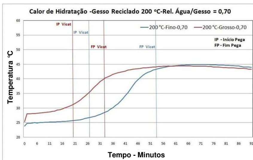
Figura 4.12 – Curva de Evolução de Temperatura - Gesso Reciclado 200 °C - Rel. Água/Gesso = 0,70.
