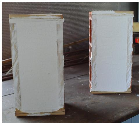
Figura 4.61 – Blocos cerâmicos de alvenaria estrutural depois da aplicação de pasta de gesso reciclado grosso (direita) e fino (esquerda) calcinado a 180 °C como revestimento.
