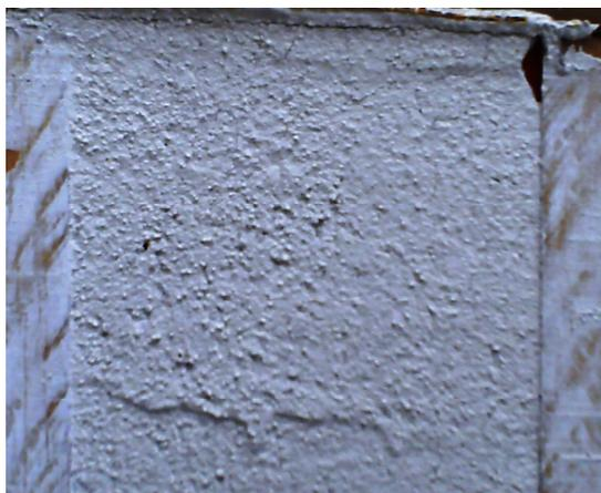
Figura 4.68 - Detalhes de fissuras de retração em revestimento de pasta de gesso reciclado grosso calcinado a 200 °C.
