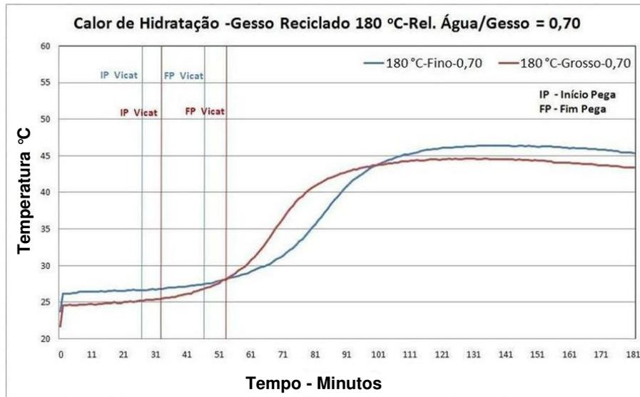
Figura 4.11 – Curva de Evolução de Temperatura - Gesso Reciclado 180 °C - Rel. Água/Gesso = 0,70.
