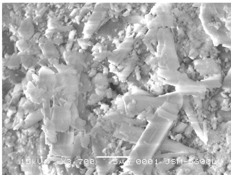
Figura 2.14 – Cristais de gesso convencional desidratado sob pressão de 0,60 atm em temperatura de 170 °C aumentados 3700 vezes em microscópio eletrônico de varredura (MEV) (MONÇÃO JÚNIOR, 2008).
