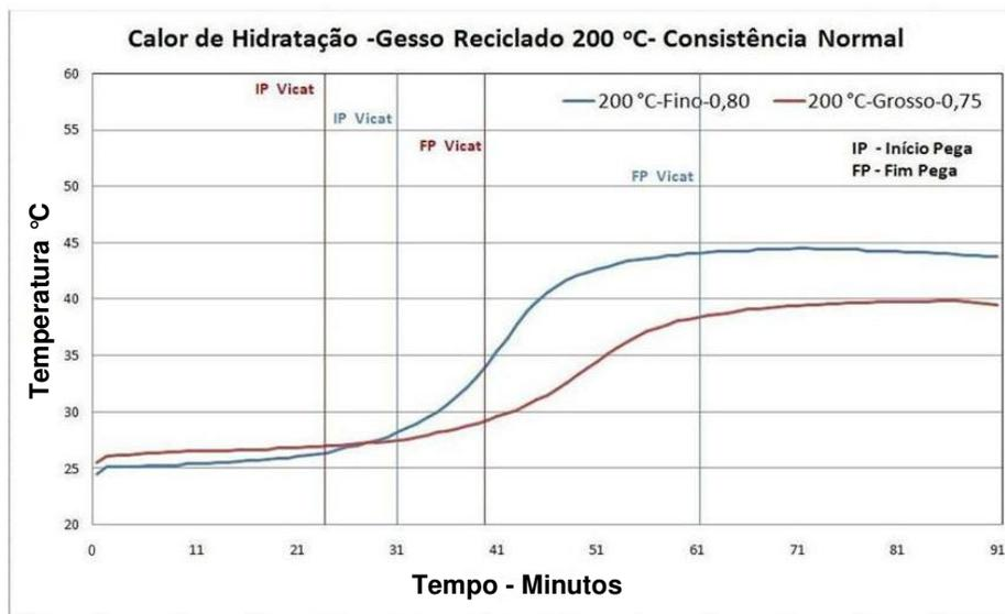
Figura 4.16 – Curva de Evolução de Temperatura - Gesso Reciclado 200 °C. Pasta de Consistência Normal.
