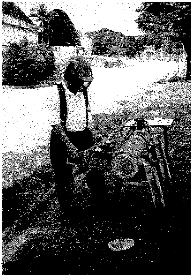
Figura 18 - Fixação do corpo de prova em cavalete
