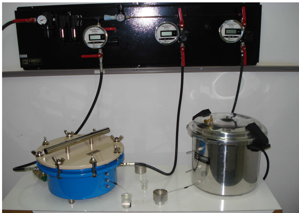
Figura 2.14 – Aparelho de Richards utilizado na técnica de translação de eixos.
