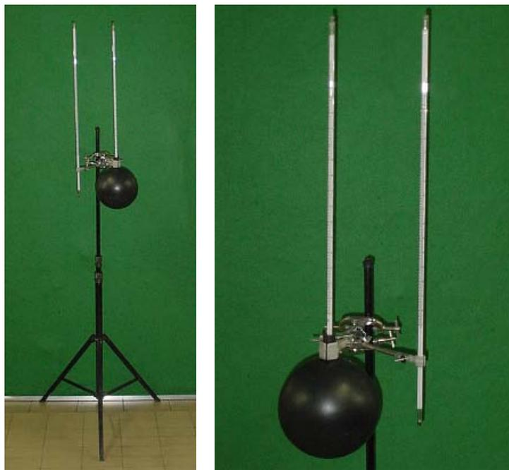
*Figura 8 – Termômetro de globo utilizado nas medições*
