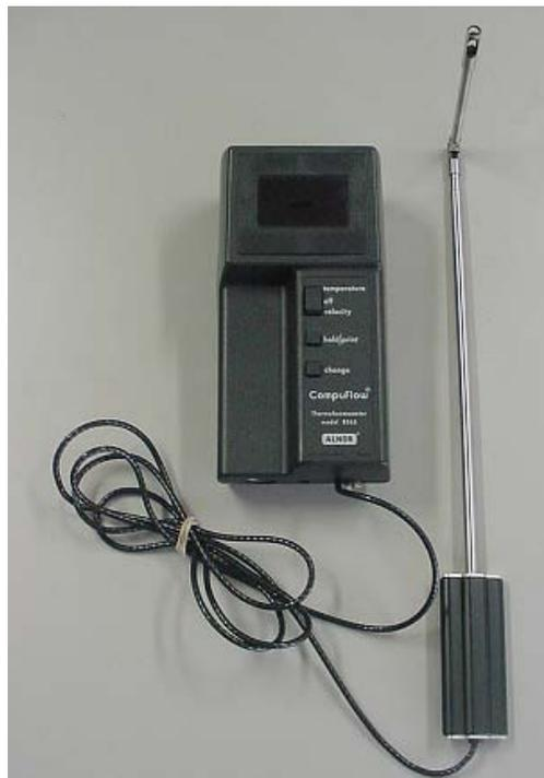
*Figura 9 – Termoanemômetro utilizado nos trabalhos de campo*
