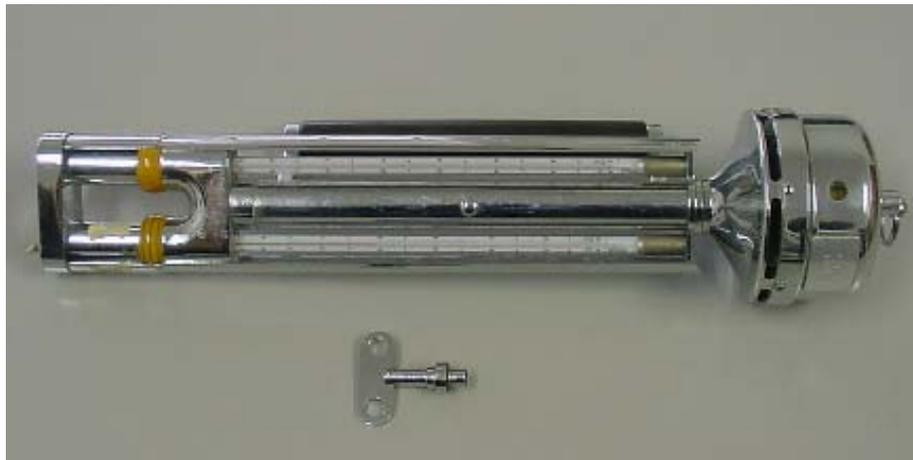
*Figura 7 – Psicrômetro utilizado nas medições*
