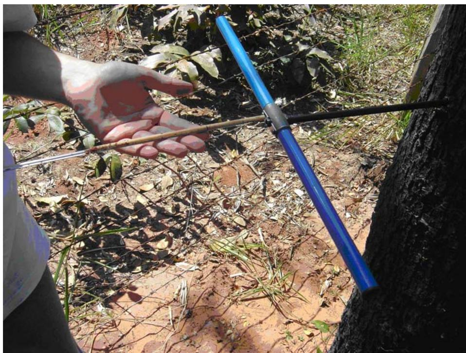
**Figura 5.5.** – Introdução da sonda de amostragem.
