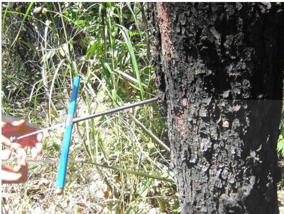
**Figura 5.4:** Sonda metálica de 5 mm para a extração de amostra.
