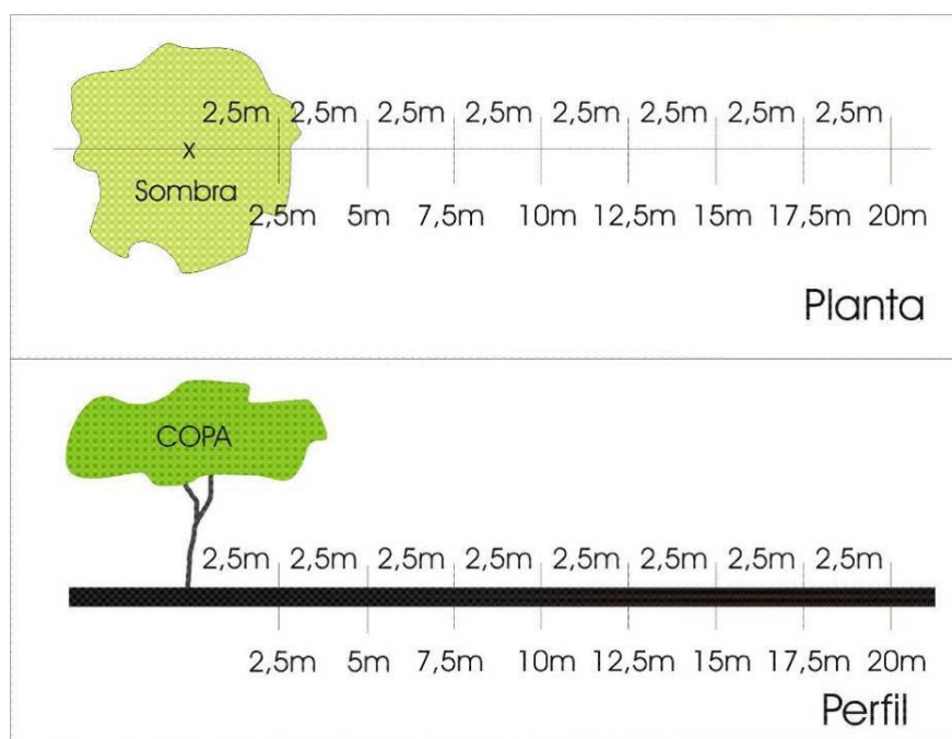
Figura 24 – Posicionamento dos registradores: experimento 02
