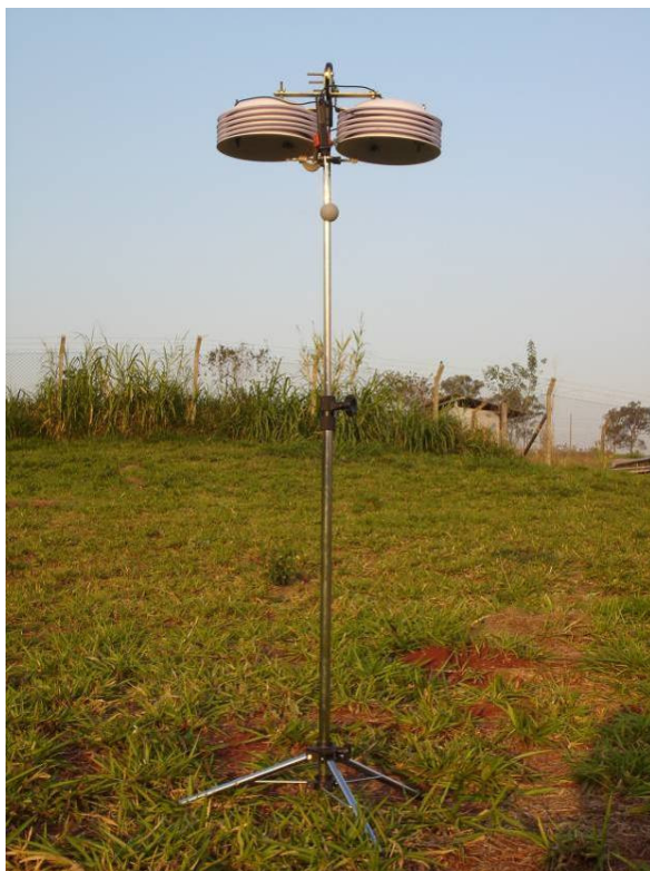
Figura 19 – Tripé fixado com registradores protegidos
