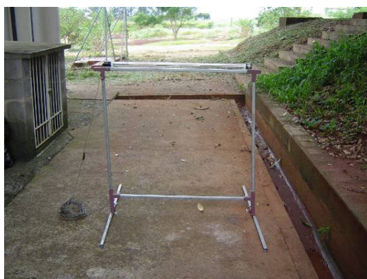
Figura 22 – Solarímetro de tubo, Delta-T TSL
