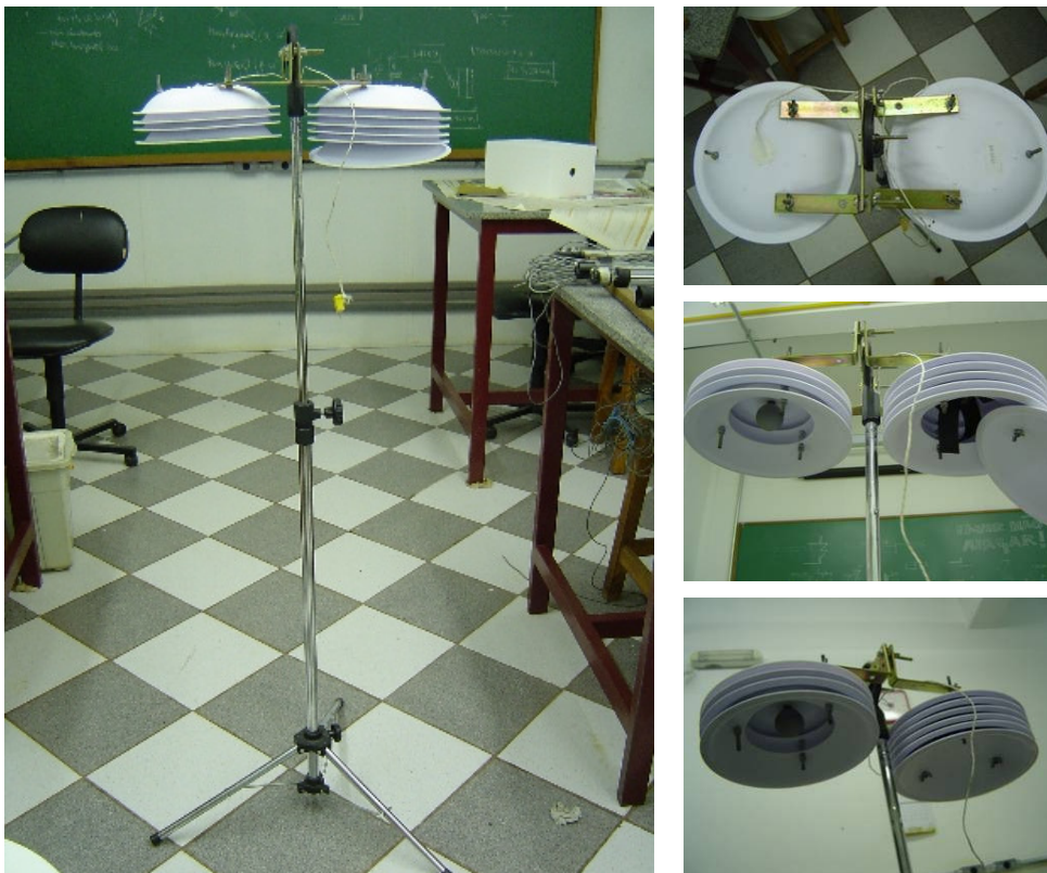
Figura 20 – Primeiro tripé utilizado com registradores e globo proteções
