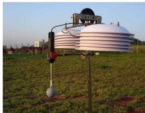
Figura 19 – Tripé fixado com registradores protegidos
