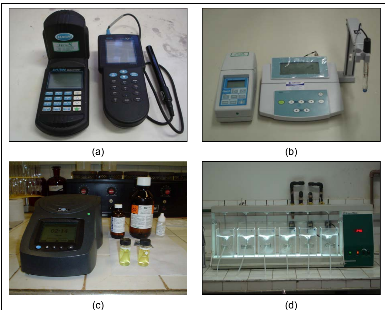
Figura 4.1 Colorímetro e condutivímetro (a); pHmêtro de bancada e turbidímetro; espectrofotômetro DR 2500 da Hach (c) e equipamento “jar-test” (d)
