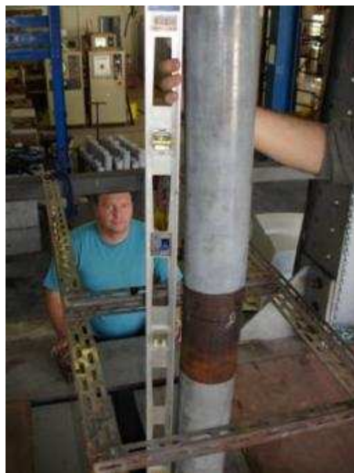
Figura 8.2 – Ruptura das amostras por instabilidade global. RT-T114-C00-1 à esquerda e, RT-T114-C00-2 à direita
