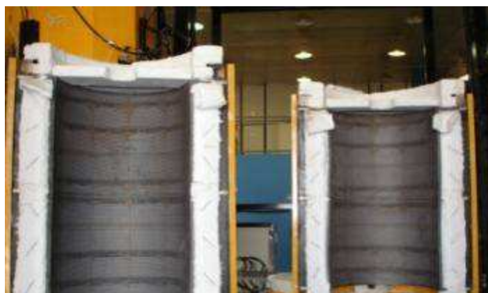
Figura 7.2 – Forno Vertical Forno Vertical para ensaio de pilares Laboratório de Estruturas – FEC – UNICAMP
