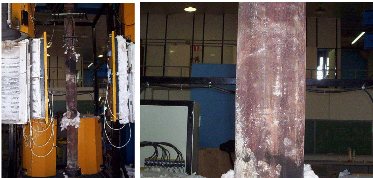
Figura 8.49 – Aspecto Final da Amostra – FC-T168-C25-30-1, à esquerda aspecto geral, à direita, detalhe da flambagem local do perfil
