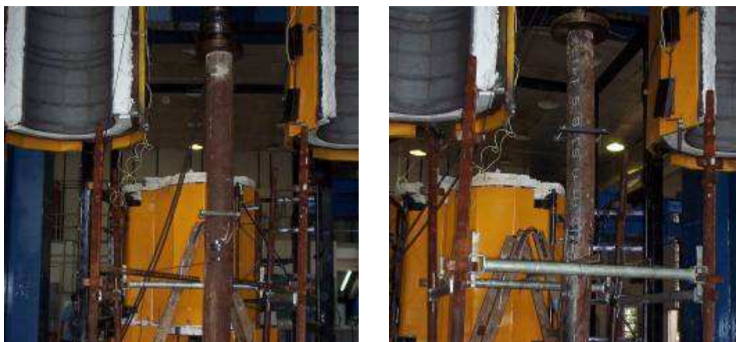
Figura 8.4 – Ruptura das amostras por instabilidade global. RT-T168-C00-1 à esquerda e, RT-T168-C00-2 à direita
