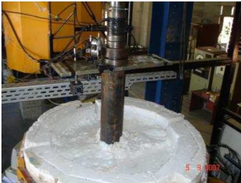
Figura 7.6 – Vedação externa do forno
