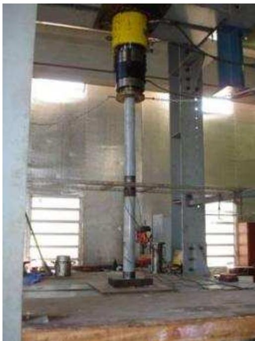
Figura 8.2 – Ruptura das amostras por instabilidade global. RT-T114-C00-1 à esquerda e, RT-T114-C00-2 à direita
