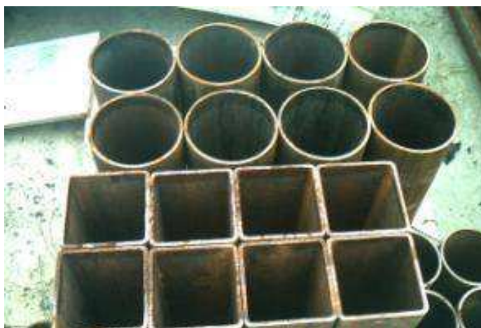
Figura 7.10 – Posicionamento das amostras para concretagem
