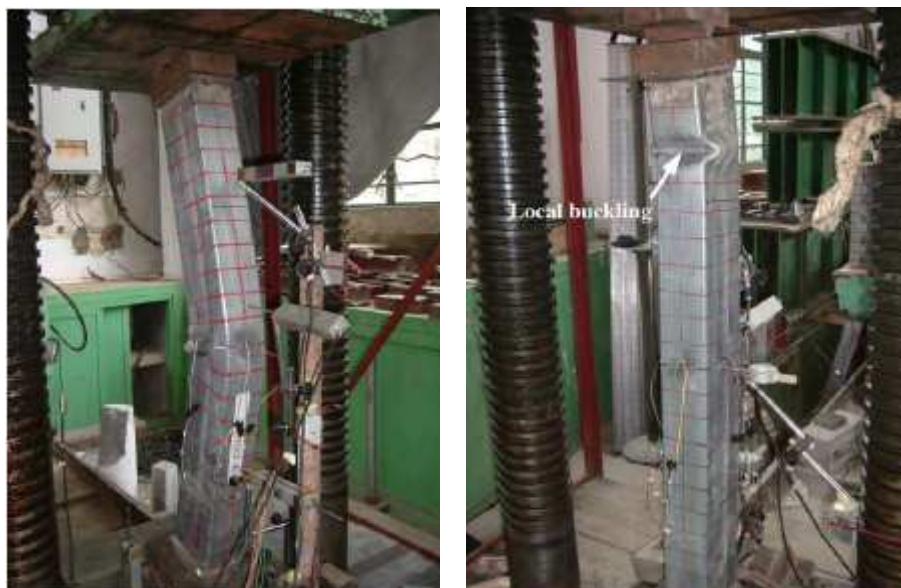
Figura 5.3 – Ruptura típica das amostras
