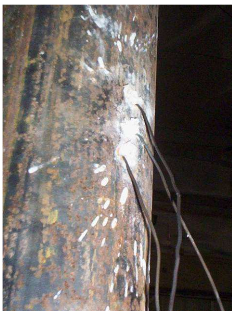
Figura 8.33 – Posicionamento dos Termopares na Amostra
