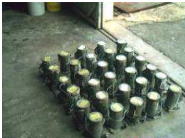
Figura 7.12 – Retirada de Corpos de Prova
