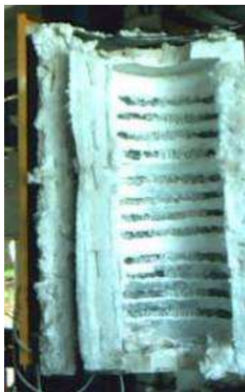
Figura 7.4 – Módulo interno do forno
