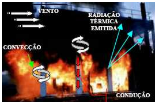
Figura 2.7 – Mecanismos de transferência de calor em uma estrutura sob incêndio
