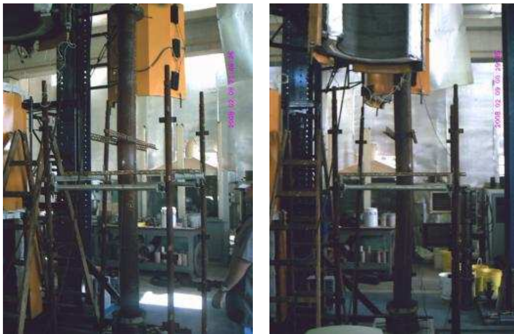
Figura 8.4 – Ruptura das amostras por instabilidade global. RT-T168-C00-1 à esquerda e, RT-T168-C00-2 à direita
