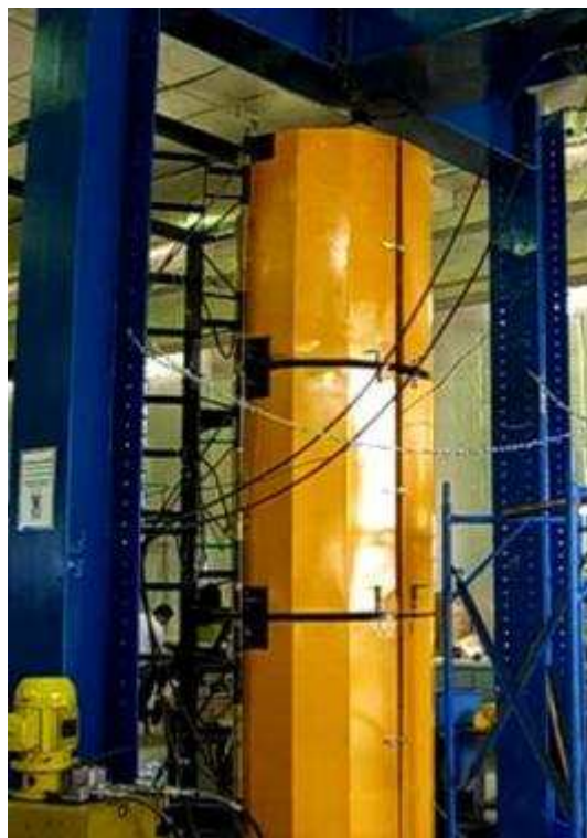
Figura 7.2 – Forno Vertical Forno Vertical para ensaio de pilares Laboratório de Estruturas – FEC – UNICAMP
