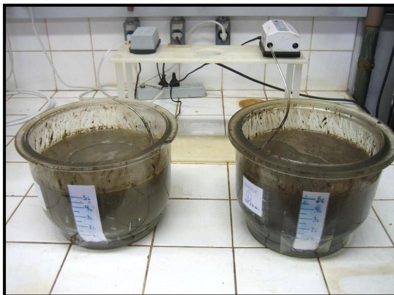
**Figura 4.3.** Reatores de aclimação das duas biomassas.
