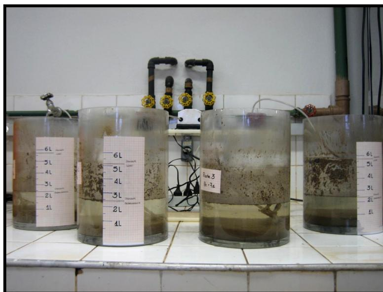
**Figura 4.8.** Aspecto dos reatores após descarte do sobrenadante.
