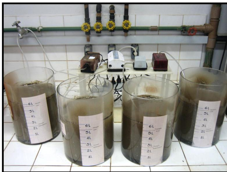
**Figura 4.4.** Os quatro reatores LAB em bancada.
