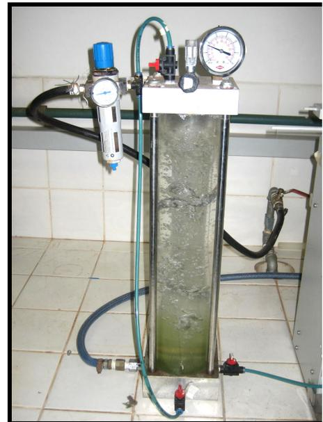
**Figura 4.10.** Câmara de pressurização.
