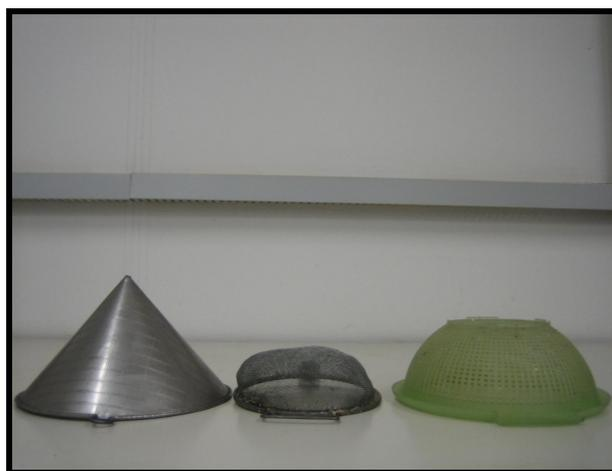
**Figura 4.2.** Aspecto das peneiras usadas para realizar a remoção dos sólidos grosseiros..
