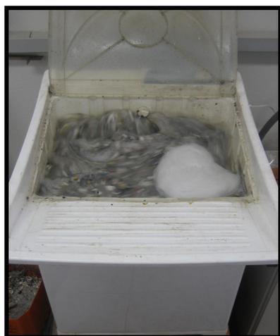
**Figura 4.1.** Máquina de turbilhonamento durante a etapa de simulação da lavagem.
