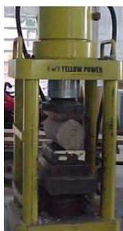
Figura 109 - Esquema do ensaio de tração por compressão diametral
