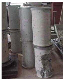
Figura 111 - Corpos-de-prova rompidos
