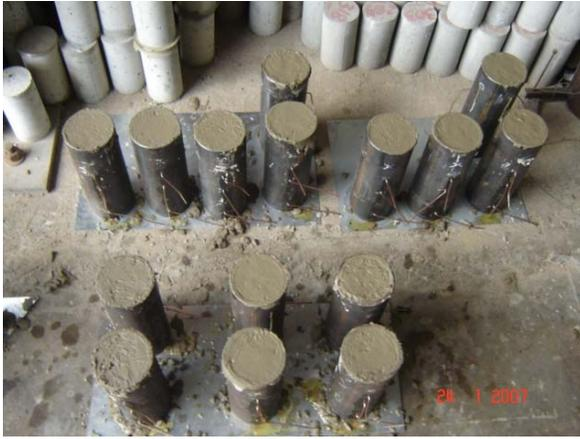
Figura 32 - Superfície dos tubos regularizada
