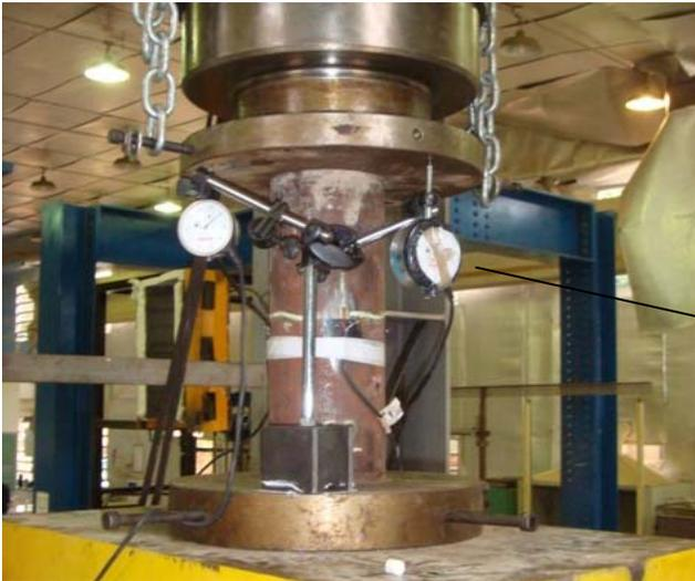
Relógios Comparadores para medir o deslocamento longitudinal dos Pilares Mistos
