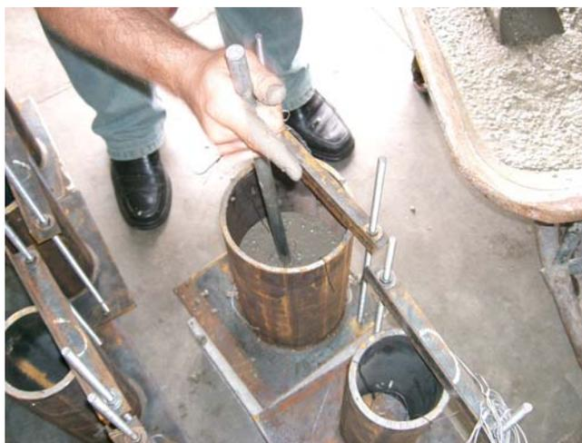
Figura 21 - Moldagem dos Pilares Mistos
