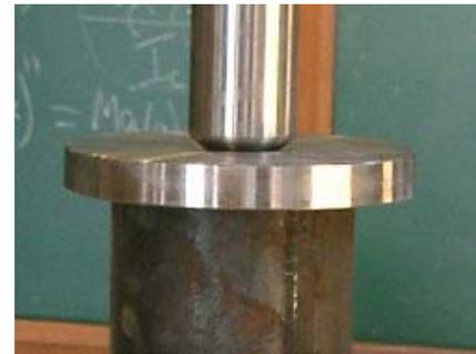
Figura 24 - Haste e flange para aplicação de carga
