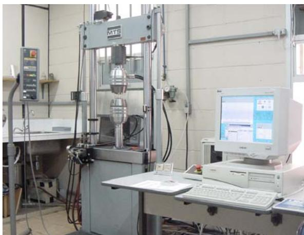
Figura 115 - Equipamento para ensaio do aço
