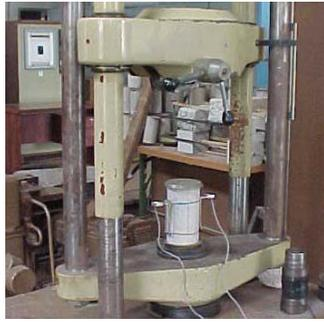
Figura 112 - Prensa usada no ensaio de módulo
