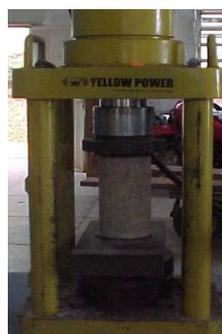
Figura 110 - Ensaio de compressão
