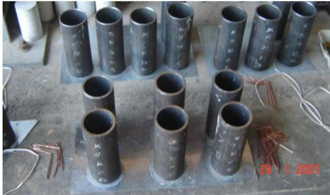
Figura 30 - Tubos posicionados para concretagem
