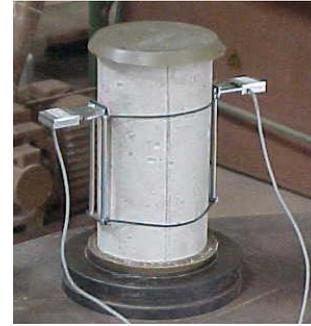
Figura 113 - Instrumentação para obtenção do módulo
