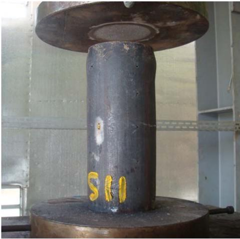
Figura 46 - Pilar misto deformado
