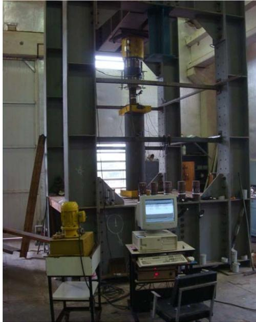
Figura 44 - Aquisitor de dados, micro-computador e bomba hidráulica.
