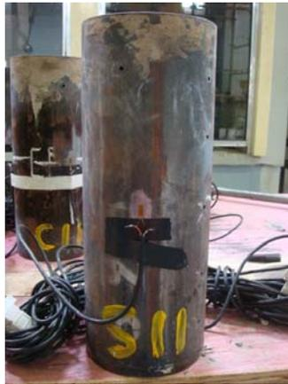
Figura 41 - Posicionamento dos strain-gages nos pilares mistos
