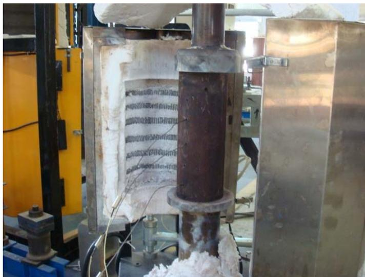
Figura 34 - Pilar misto dentro do forno
