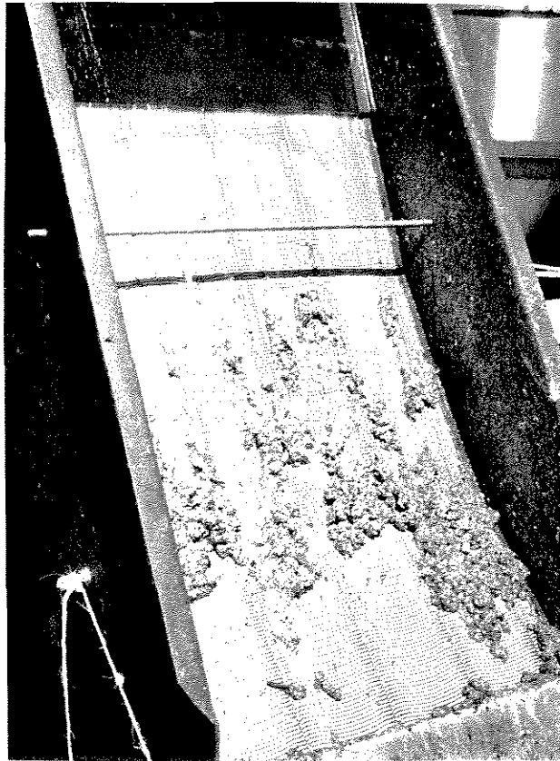
FIGURA 8 - Peneira estática em operação
