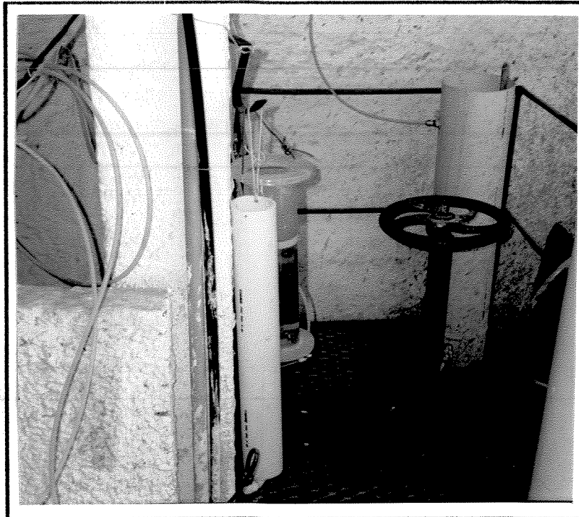
FIGURA 4.9 - Visão Geral das Colunas de Produção, Excesso e de Destruição de Ozônio.
