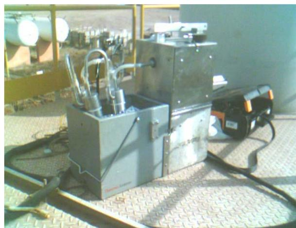
**Figura 5.10** - Sistema de resfriamento de gases com os borbulhadores em série.
