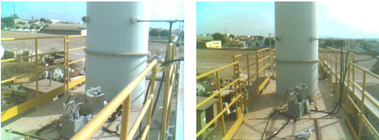
**Figura 5.14** - Trem de amostragem para a coleta de Fluoreto com a coleta em andamento.
