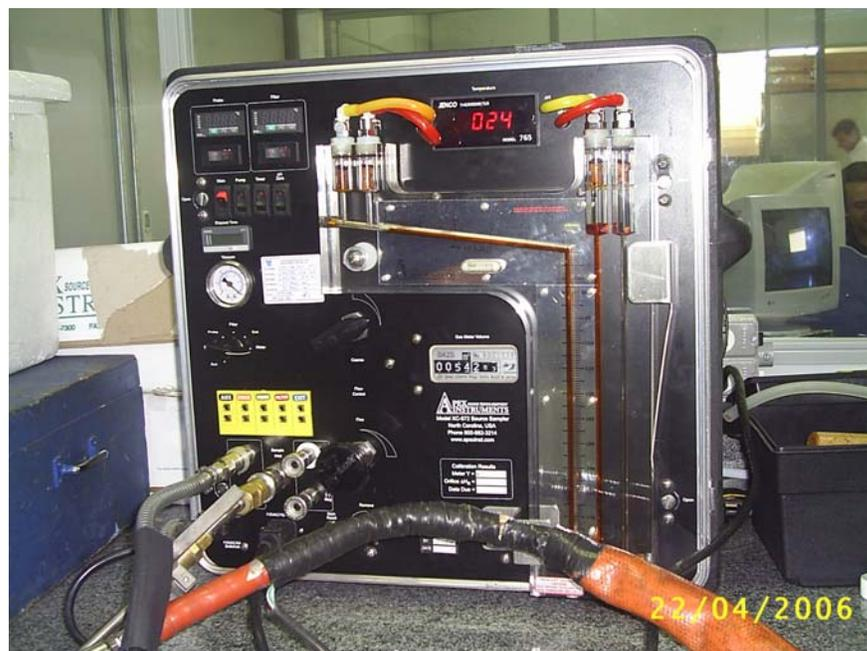
**Figura 5.11** - Modelo de Equipamento de Controle de Poluição utilizado nas amostragens de Emissões Atmosféricas.
