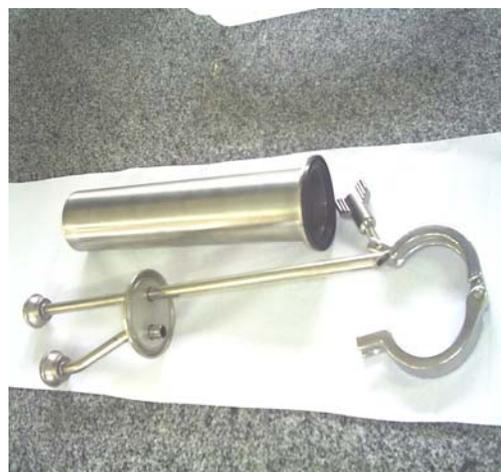
**Figura 5.9** - Modelo de Borbulhador de Aço Inox tipo Greenburg-Smith.
