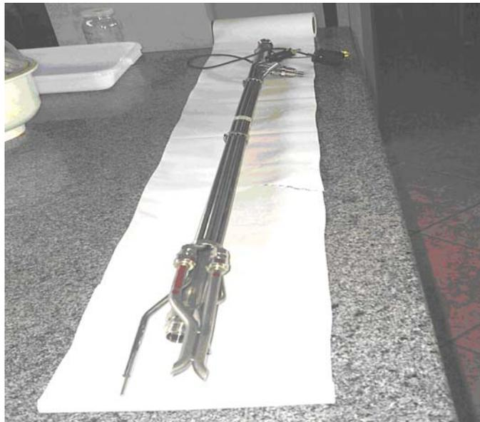
**Figura 5.6** - Sonda de amostragem.
