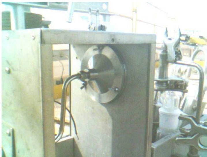
**Figura 5.8** - Sistema de aquecimento de gases (Caixa Quente).
