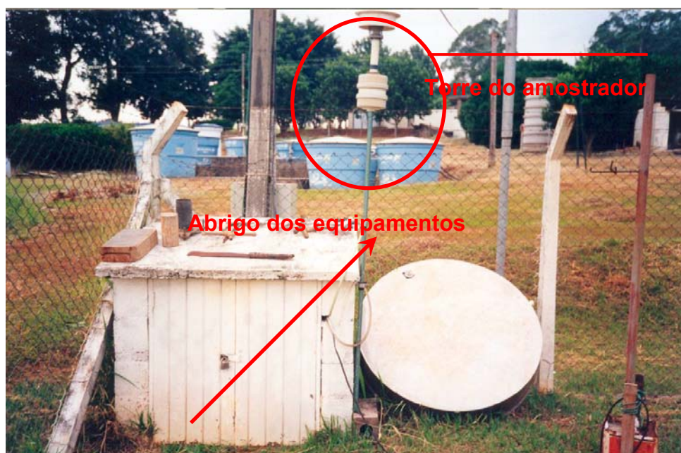
Figura 5.4 – Vista externa da estação montada na FEAGRI, com destaque para torre do amostrador (equipamento projetado na FEC).
