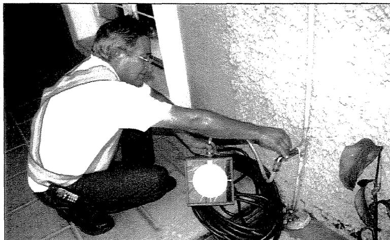
Figura 16 – Medidor de pressão e vazão com “DATA LOGGER” para localização de vazamentos (DMAE-
