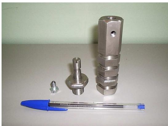
Figura 5.7 : Dispositivo de centragem forçada padrão IBGE.
