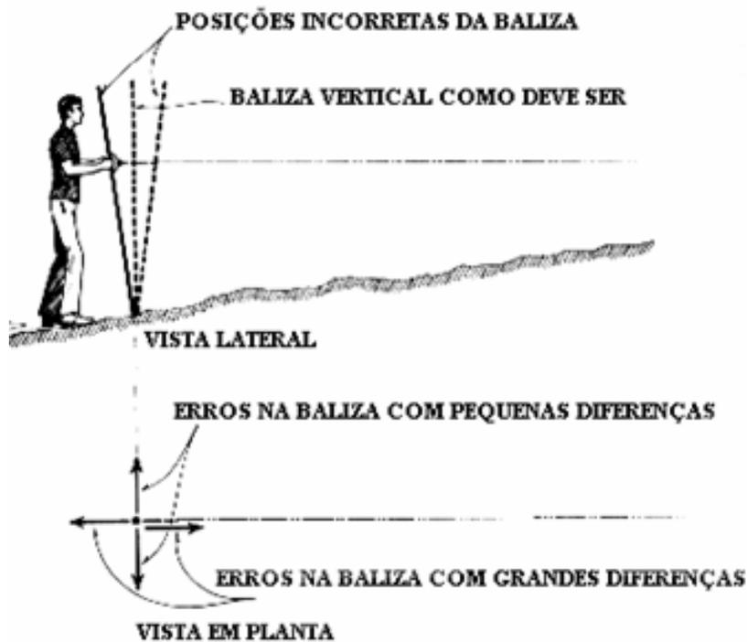
Figura 5.11 : Erro na verticalização do bastão/baliza, fonte: BORGES (1977).
