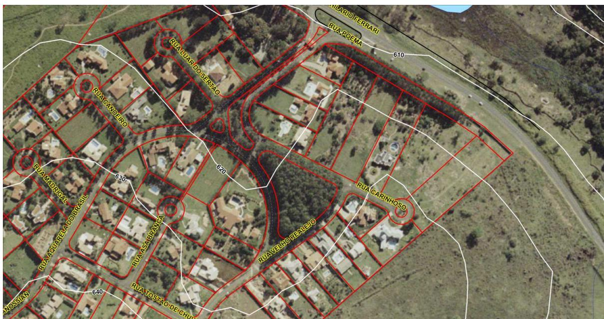
Figura 3.5 : Ortofotocarta utilizada em conjunto com feições restituídas através de fotogrametria – Salto/SP.
