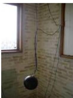
Figura 3.24 – Termômetro de globo e termopar
