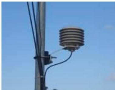
Figura 3.32 – Abrigo com sensor de temperatura e umidade do ar
