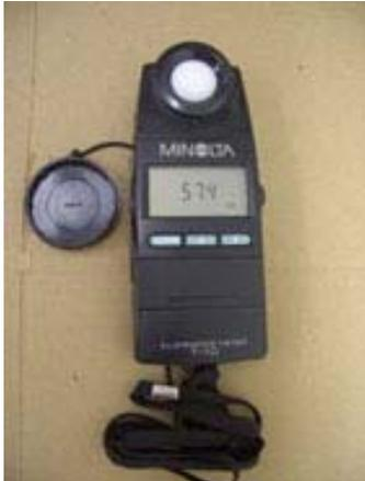
Figura 3.44 – Luxímetro marca Minolta, modelo T10
