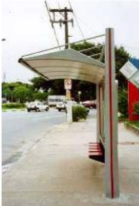
Figura 1.52 – Abrigo do ponto de ônibus em SP, utilizando policarbonato alveolar
