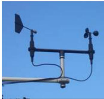
Figura 3.30 – Sensor direção e velocidade do vento
