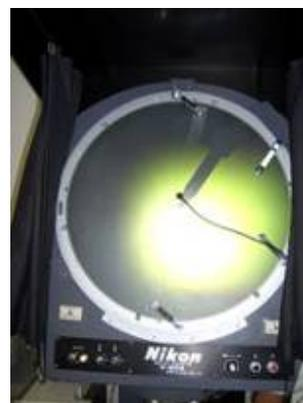
Figura 3.47 - Calibração da ponta do estileto
