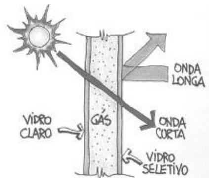
Figura 1.11 – Isolação térmica com a inserção de gás
