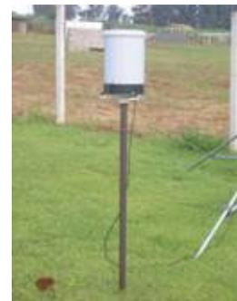
Figura 3.31 - Pluviômetro com apoio próprio, situado ao lado da estação
