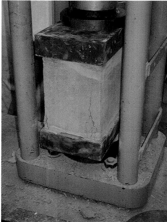
**Figura 24 – Fissuras na paredinha transversal externa de um bloco de concreto, rompido com capeamento longitudinal**
