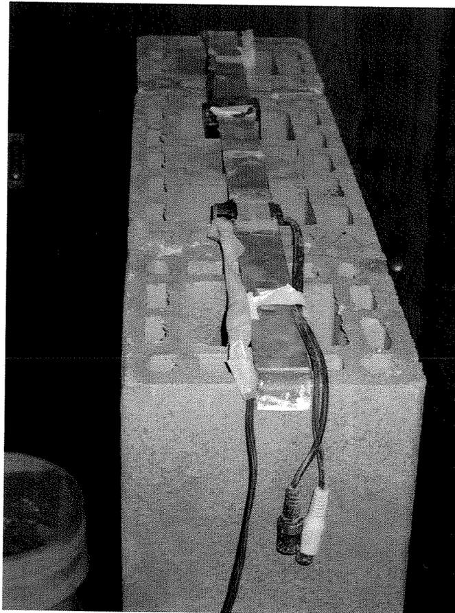
**Figura 16 – Instalação do equipamento de filmagem dentro da parede**
