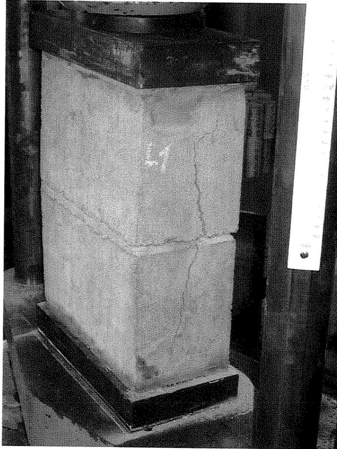
**Figura 25 – Fissuras nas paredinhas transversais dos blocos com capeamento e argamassa longitudinais**
