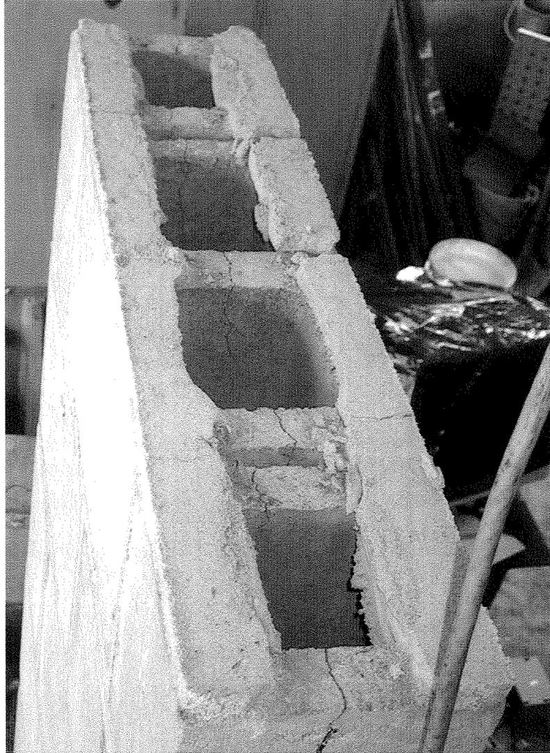
**Figura 29 – Fissuras nos septos transversais dos blocos**
