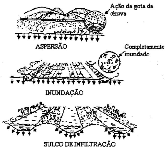
Figura 3.5 – Algumas técnicas de irrigação mais utilizadas para tratamento das águas residuárias.
