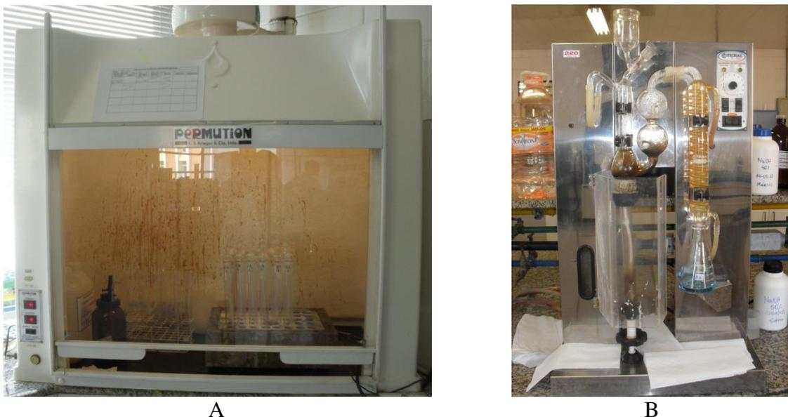
**Figura 11.** Imagem do bloco digestor inserido em capela de fluxo laminar (A) e do destilador (B) utilizados na determinação do teor de proteína dos grãos de *Moringa oleifera* L.
