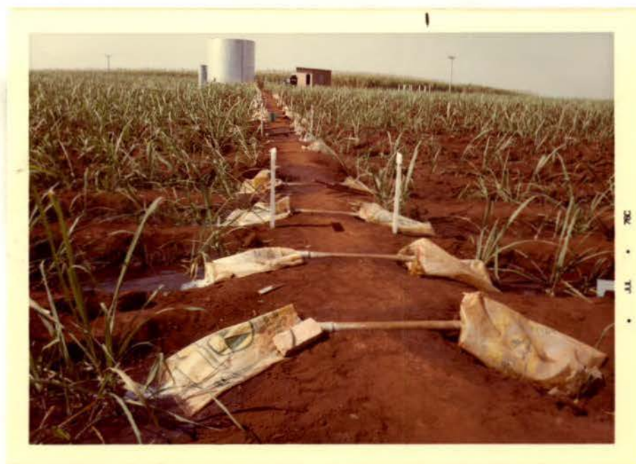
FIGURA 9. Centro de uma das seções, com tubulações de descarga para as parcelas.
