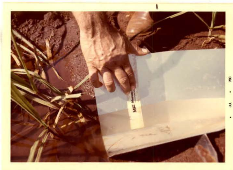
FIGURA 11 a . Detalhe da seção de entrada da calha onde foram feitas as medições da vazão.
