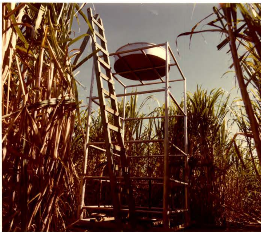
FIGURA 5. Tanque Classe A, instalado no campo experimental, sobre armação metálica com regulagem para suspender e acompanhar o crescimento da cana na altura do topo da cultura.
